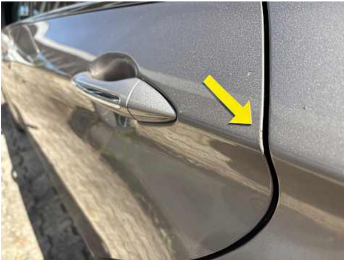
Türe hinten links (Lackschaden)
