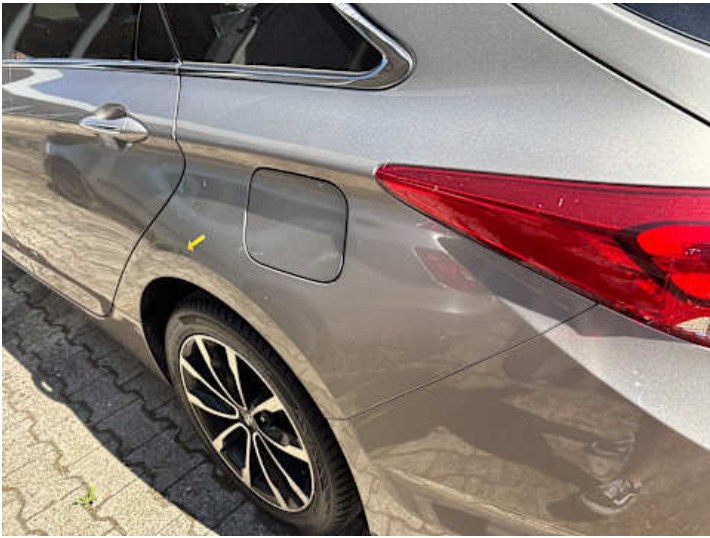
Seitenteil hinten links (Delle)
