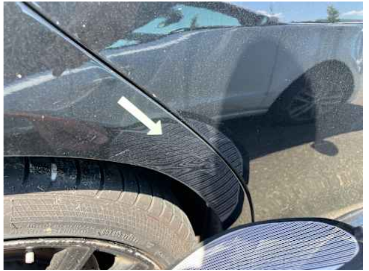
Seitenteil hinten rechts (Verformung)
