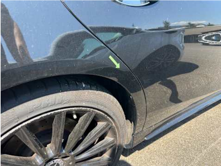
Seitenteil hinten rechts (Verformung)
