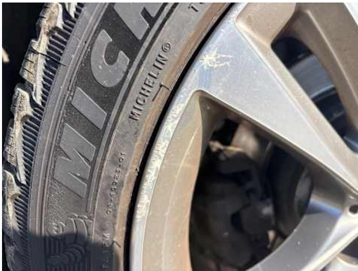
Rad (Kerben, Rost)
