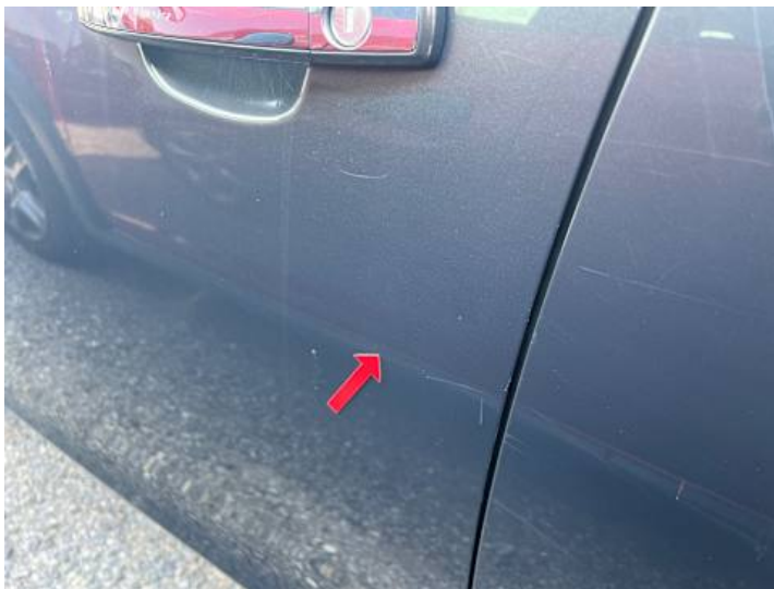
Fahrtür (Lackschaden, Kratzer)
