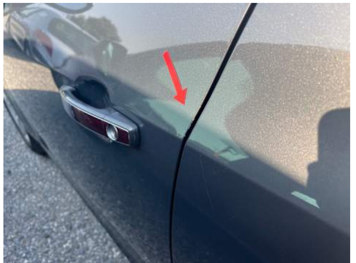
Fahrtür (Lackschaden, Kratzer)
