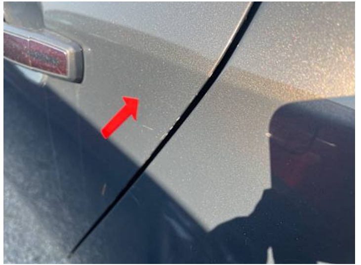
Türe hinten links (Lackschaden, Kratzer)
