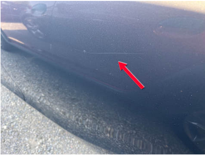
Türe hinten links (Lackschaden, Kratzer)
