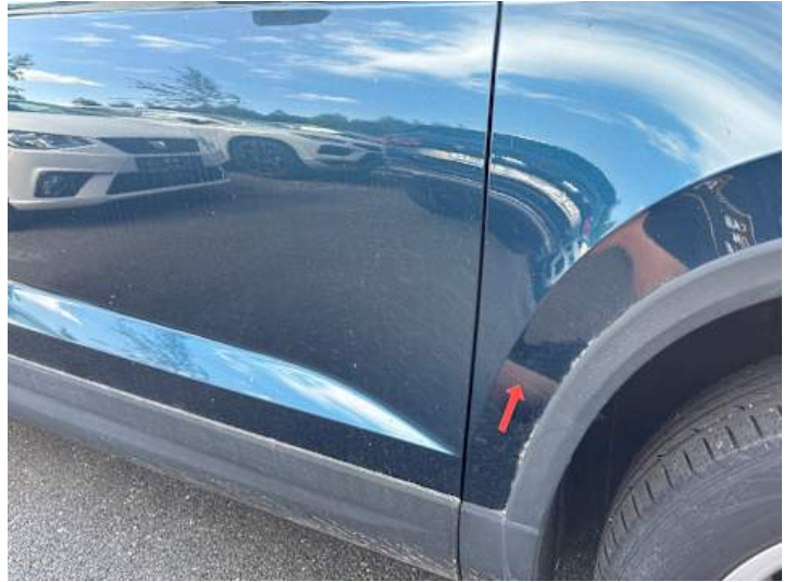
Kotflügel vorne rechts (Kratzer, Lackschaden)
