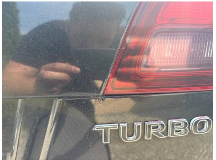
Rücklicht (rechts) (Kratzer, Riss/Bruch)
