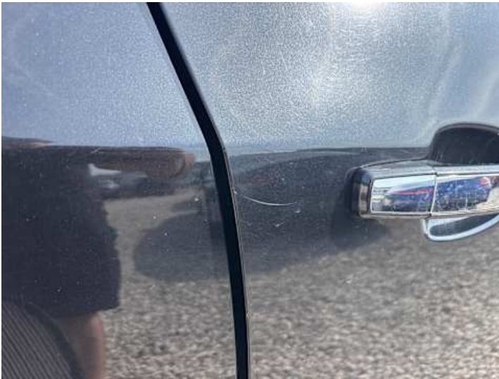
Beifahrertür (Kratzer, Lackschaden, Rost)
