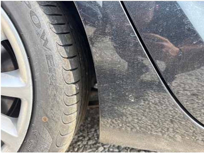
Seitenteil hinten rechts (Unsachgemäß instand gesetzt, Rost, Kratzer, Lackschaden, Delle)
