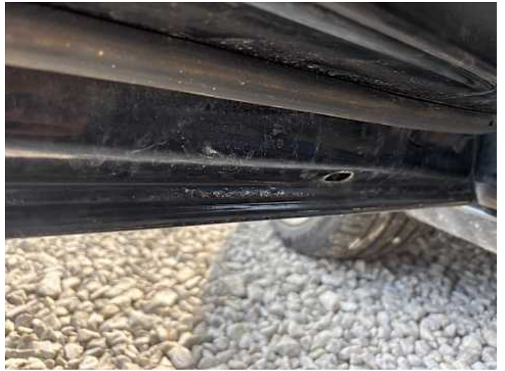
Fahrertür (Lackschaden, Rost, Riss/Bruch, Spaltmaße ungenau)
