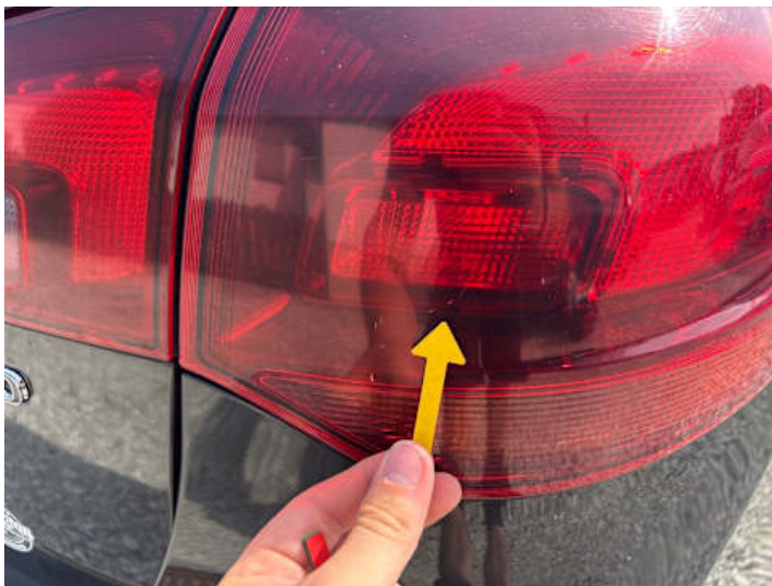
Rücklicht (rechts) (Kratzer, Riss/Bruch)
