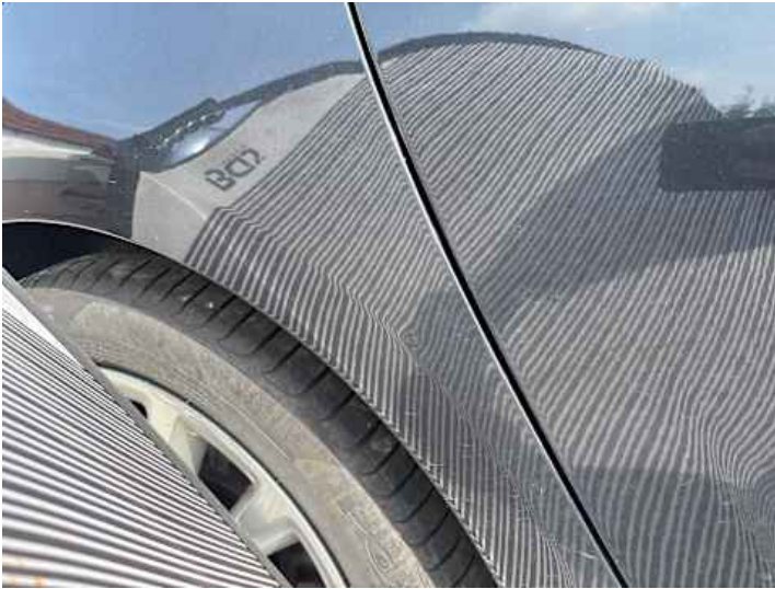
Seitenteil hinten rechts (Unsachgemäß instand gesetzt, Rost, Kratzer, Lackschaden, Delle)
