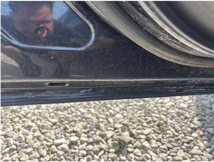
Fahrertür (Lackschaden, Rost, Riss/Bruch, Spaltmaße ungenau)
