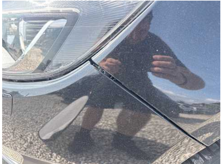
Stoßstange vorne (Spaltmaße ungenau, Verformung, Kratzer, Lackschaden, Unsachgemäß instand gesetzt)
