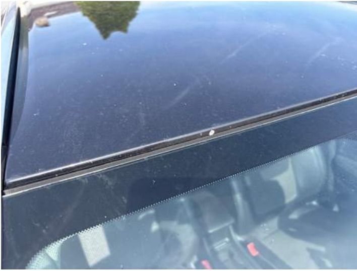
Dach (Lackschaden, Rost, Steinschlag, Unsachgemäß instand gesetzt)
