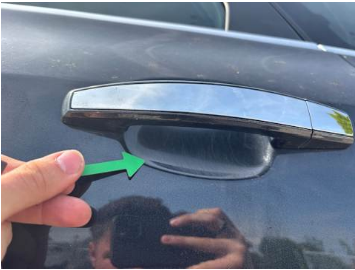
Türe hinten links (Lackschaden, Kratzer, Rost)
