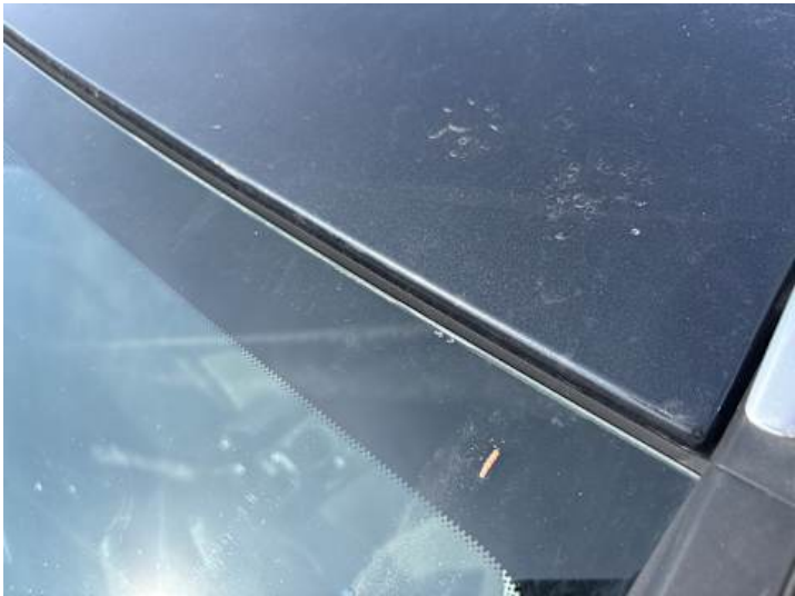
Windschutzscheibe (Anderer Schaden): Ablösung
