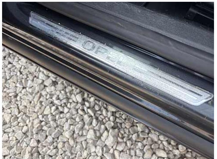
Schweller links (Kratzer, Lackschaden, Delle)
