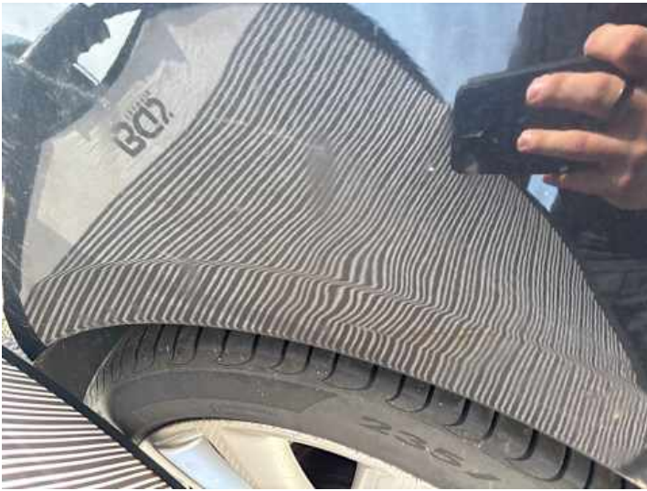
Seitenteil hinten links (Delle, Lackschaden, Unsachgemäß instand gesetzt)
