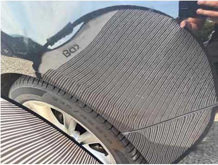
Seitenteil hinten links (Delle, Lackschaden, Unsachgemäß instand gesetzt)
