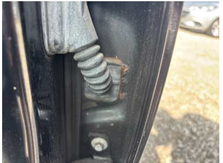
Türe hinten links (Lackschaden, Kratzer, Rost)
