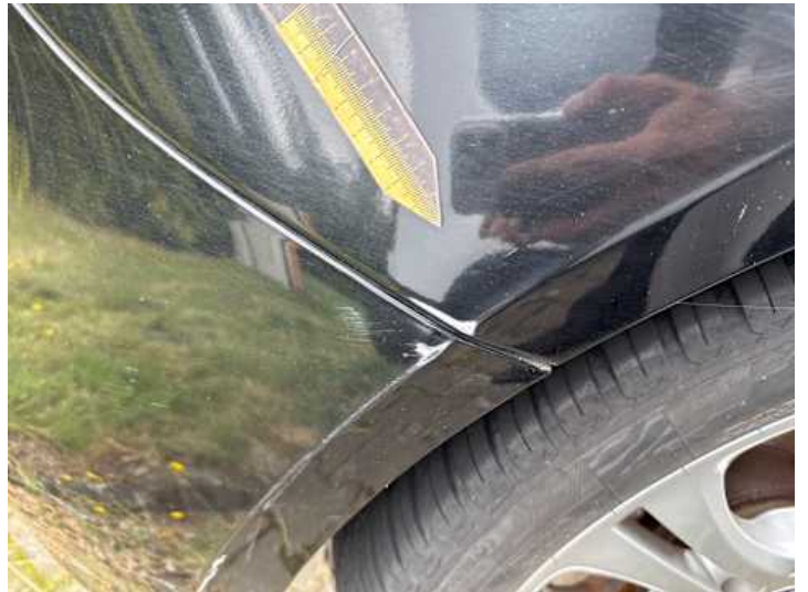
Seitenteil hinten rechts (Kratzer, Ausgeblichen/Matt)
