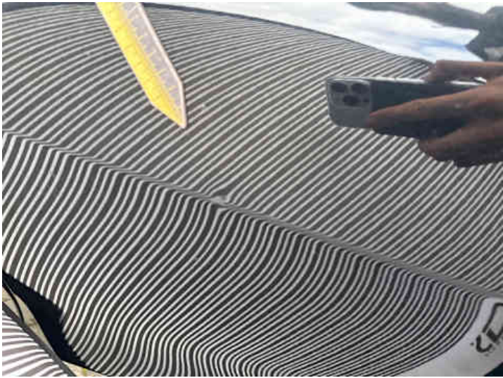
Türe hinten links (Kratzer, Delle)
