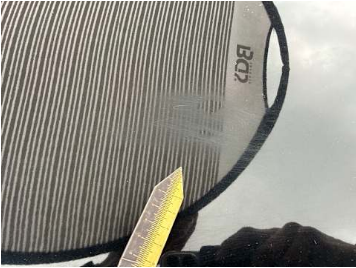
Dach (Kratzer, Ausgeblichen/Matt)
