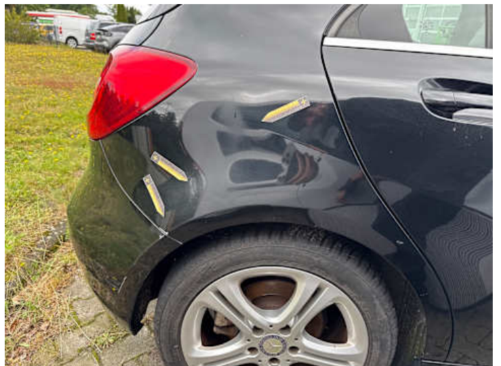
Seitenteil hinten rechts (Kratzer, Ausgeblichen/Matt)
