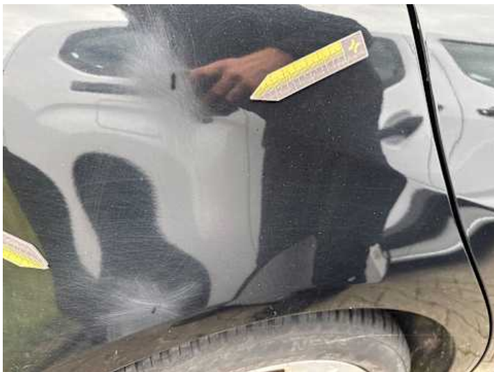
Seitenteil hinten rechts (Kratzer, Ausgeblichen/Matt)
