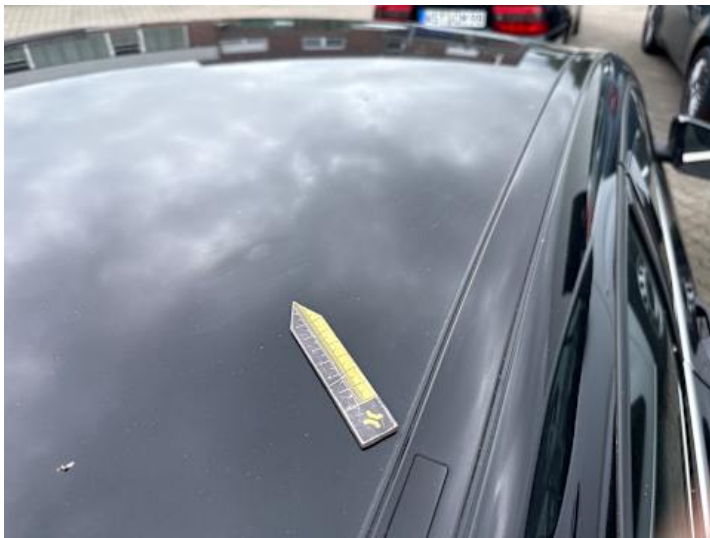
Dach (Kratzer, Ausgeblichen/Matt)
