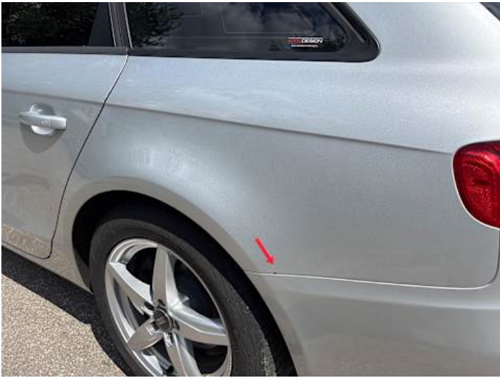
Seitenteil hinten links (Rost)
