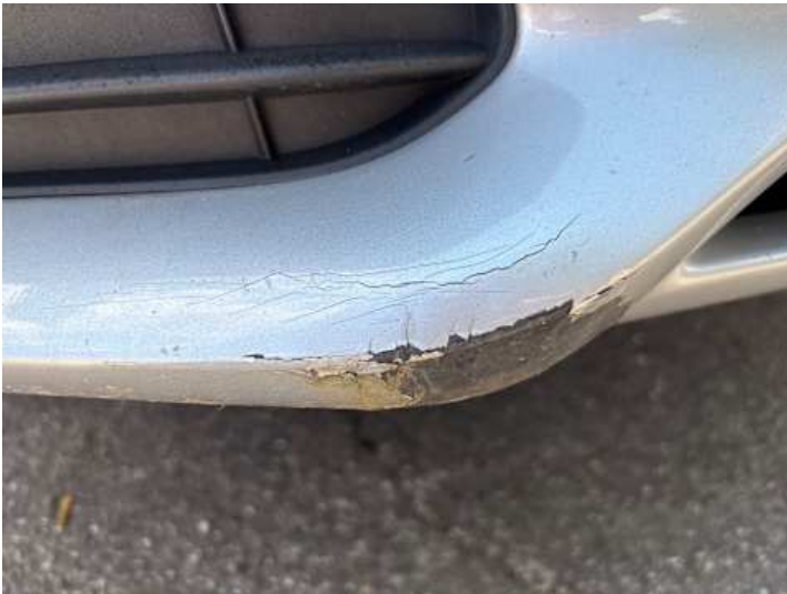
Stoßstange vorne (Riss/Bruch)
