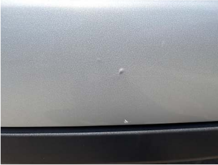
Stoßstange hinten (Riss/Bruch)
