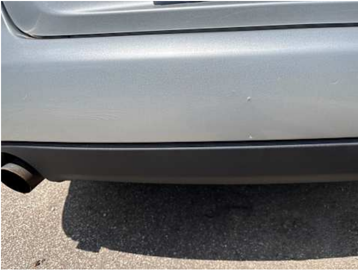
Stoßstange hinten (Riss/Bruch)
