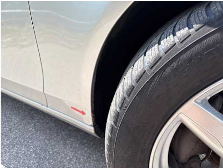
Kotflügel vorne rechts (Rost)
