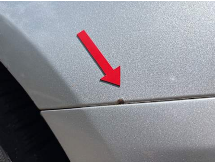
Seitenteil hinten links (Rost)
