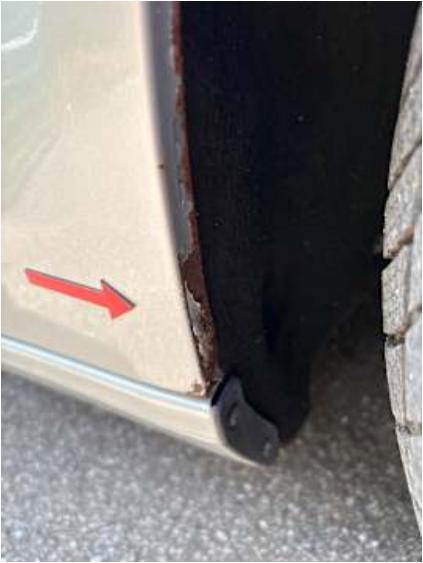
Kotflügel vorne rechts (Rost)
