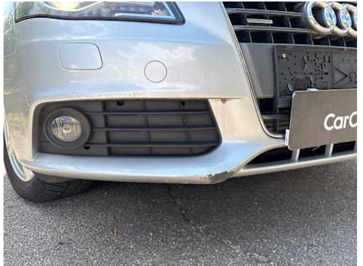
Stoßstange vorne (Riss/Bruch)
