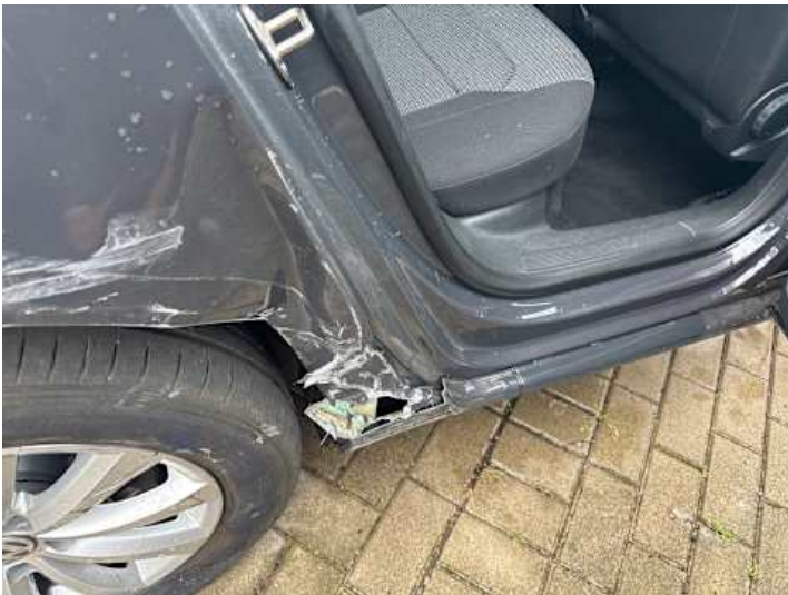
Türe hinten rechts (Lackschaden, Verformung)
