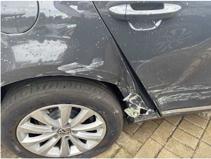
Seitenteil hinten rechts (Lackschaden, Riss/Bruch, Verformung)
