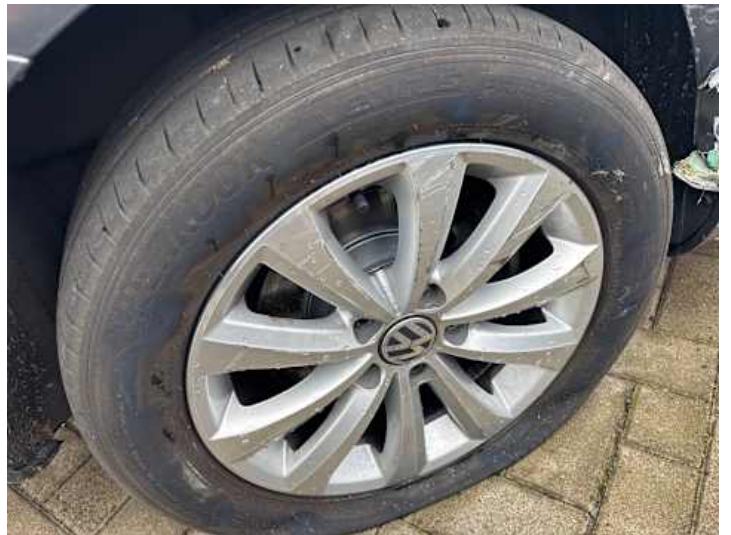
Rad (Riss/Bruch, Ohne Luft)
