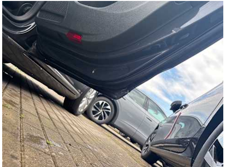
Türe hinten rechts (Lackschaden, Verformung)
