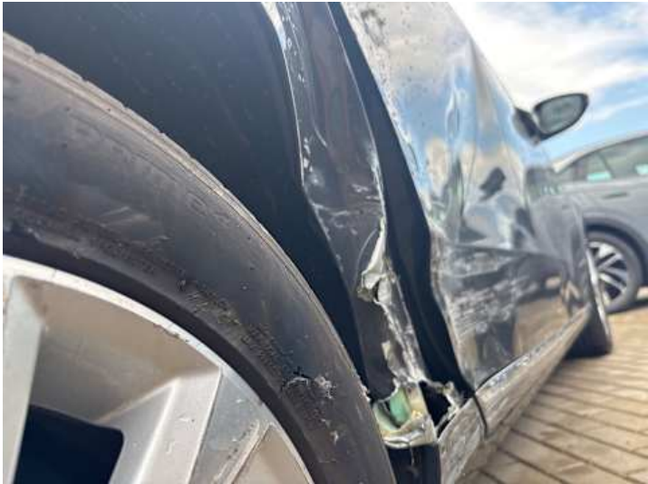
Seitenteil hinten rechts (Lackschaden, Riss/Bruch, Verformung)
