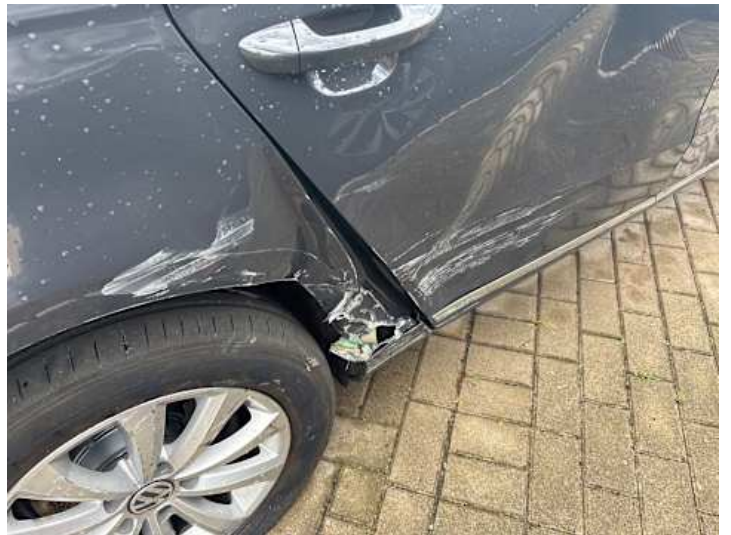
Türe hinten rechts (Lackschaden, Verformung)
