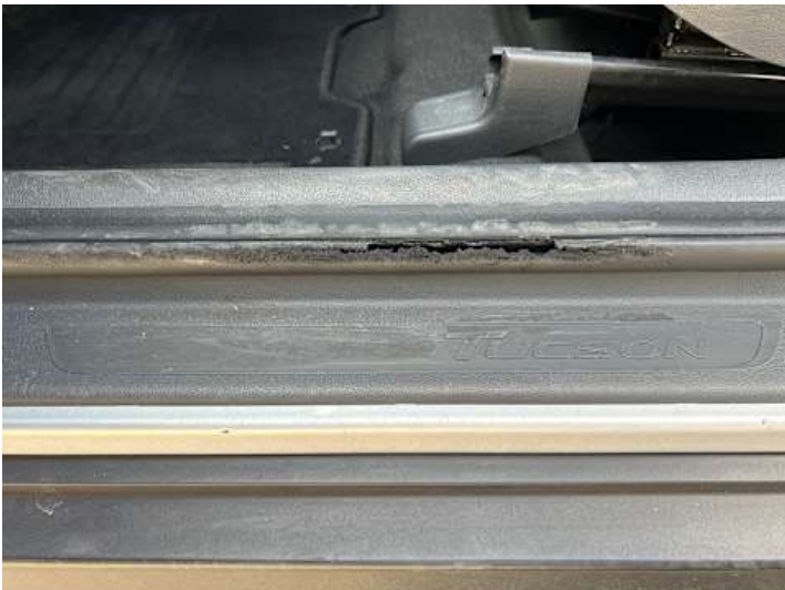
Fahrtür (Anderer Schaden): Türgummi porös
