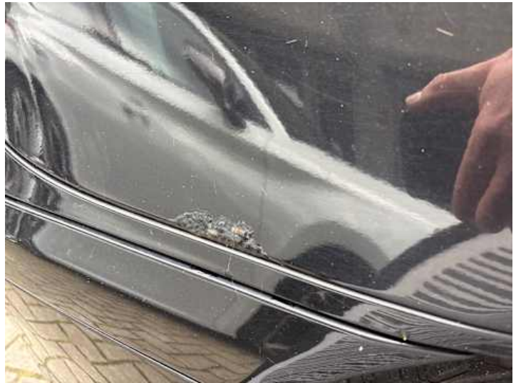
Seitenteil hinten rechts (Rost)
