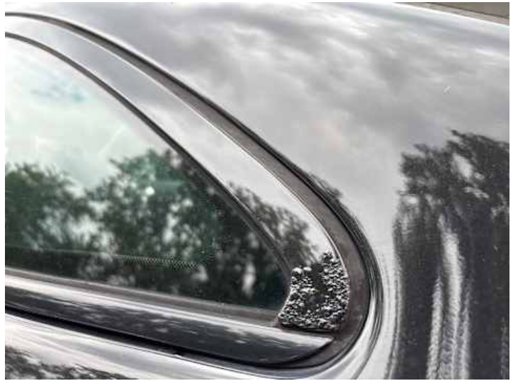
Seitenteil hinten links (Rost)
