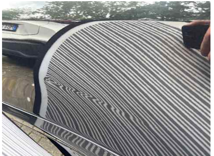
Seitenteil hinten links (Verformung)
