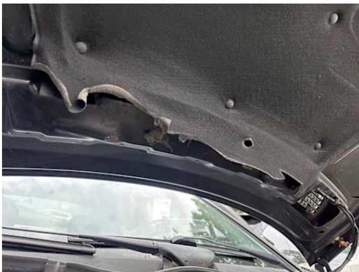
Motorhaube (Anderer Schaden): Dämmung beschädigt
