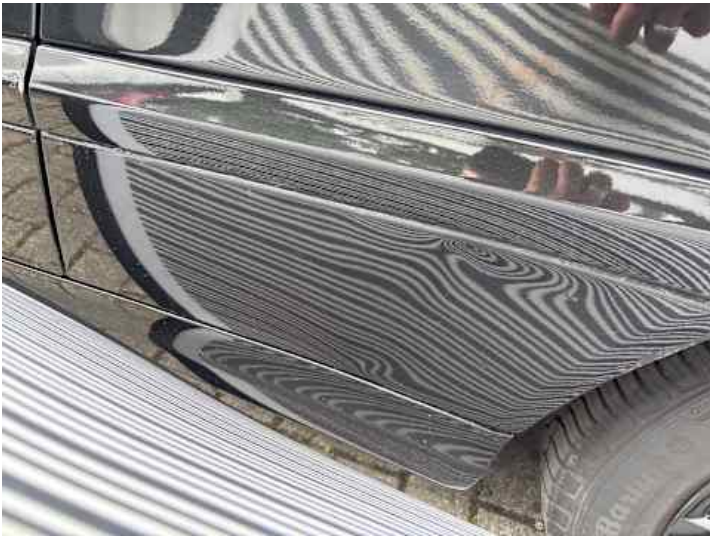
Seitenteil hinten links (Verformung)
