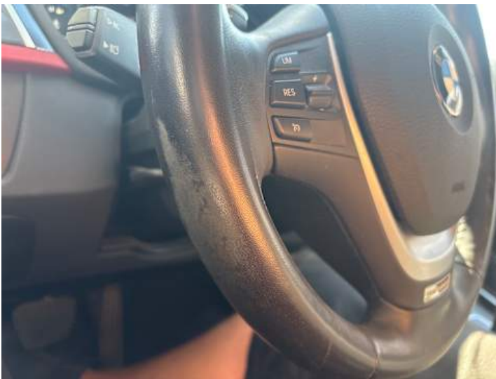
Innenraum (Verschleiß, Kratzer)
