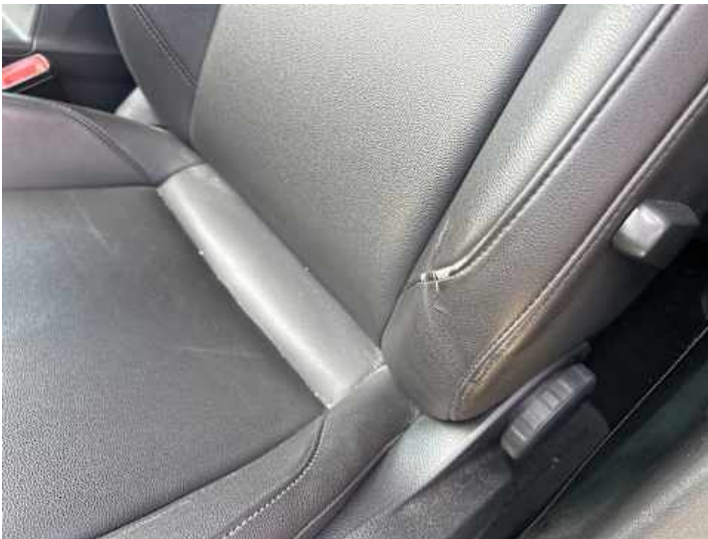
Innenraum (Verschleiß, Riss/Bruch)
