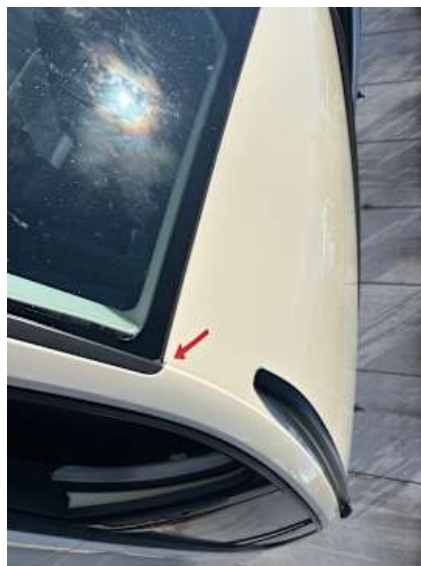
Dach (Steinschlag, Rost)
