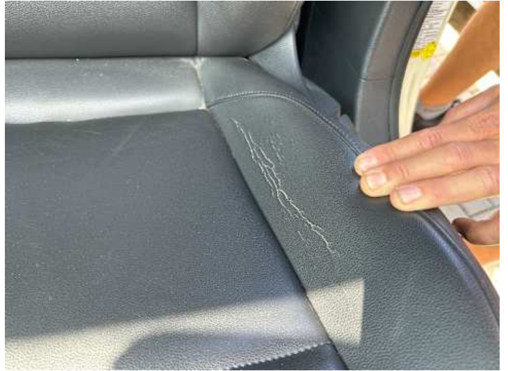
Innenraum (Verschleiß, Riss/Bruch)
