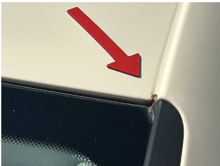
Dach (Steinschlag, Rost)
