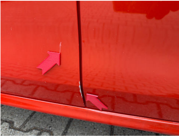
Fahrtür (Lackschaden, Kratzer)
