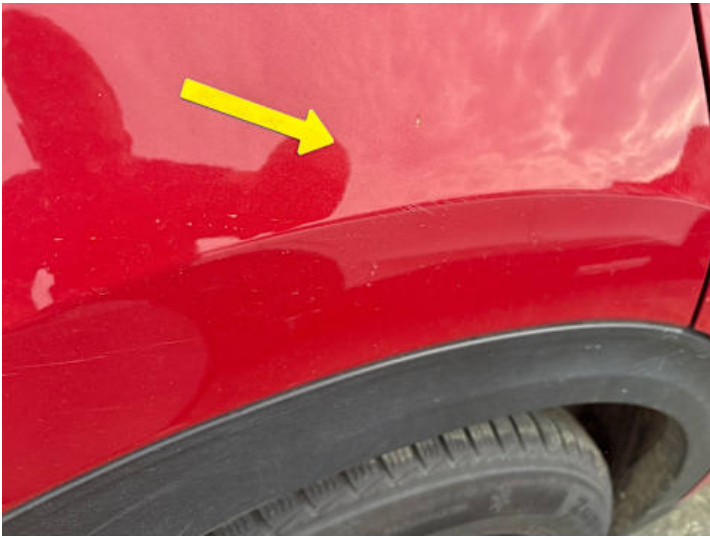
Seitenteil hinten rechts (Kratzer)
