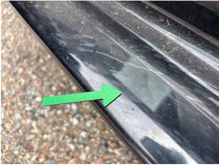
Schweller links (Rost)
