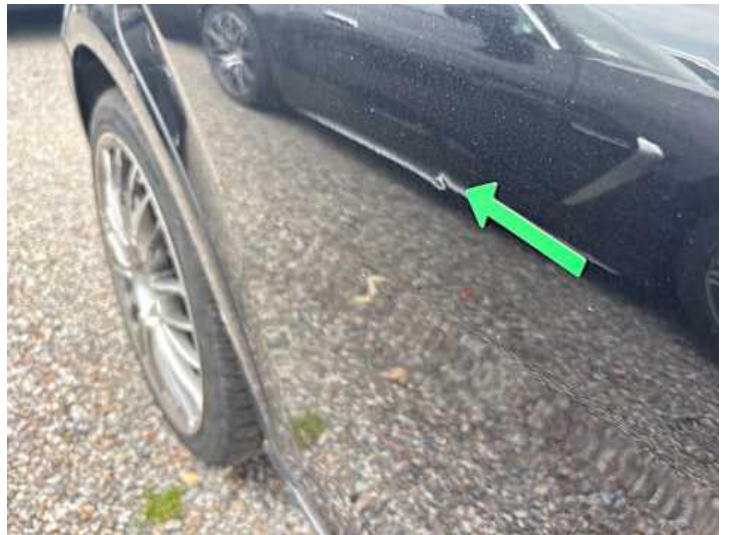
Türe hinten rechts (Delle)
