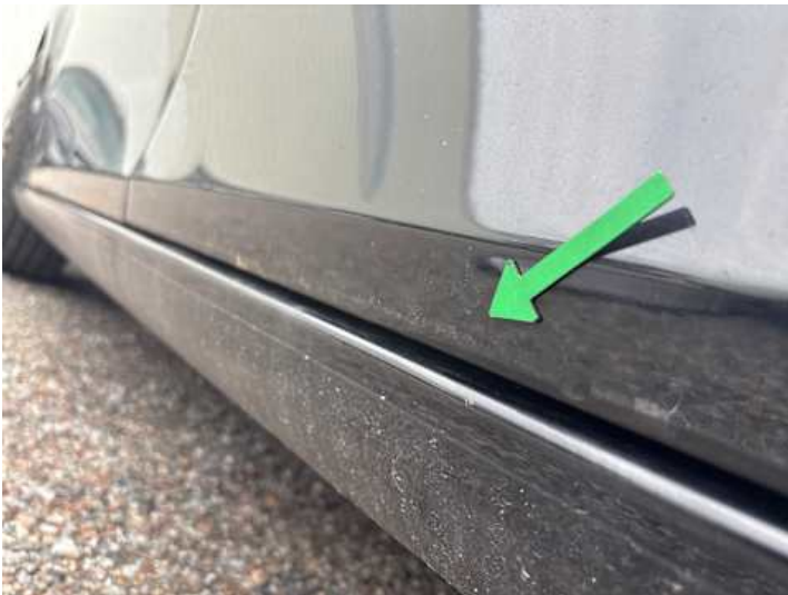
Türe hinten links (Rost)
