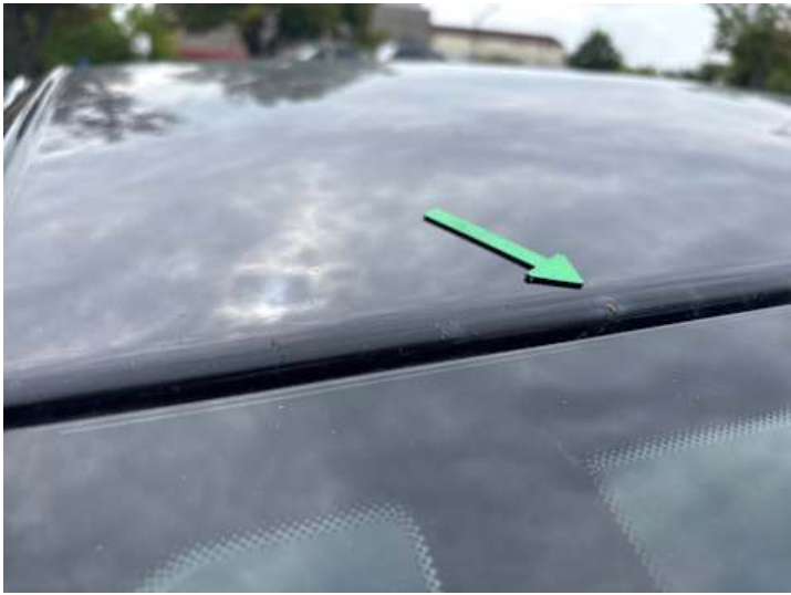
Dach (Steinschlag, Rost)
