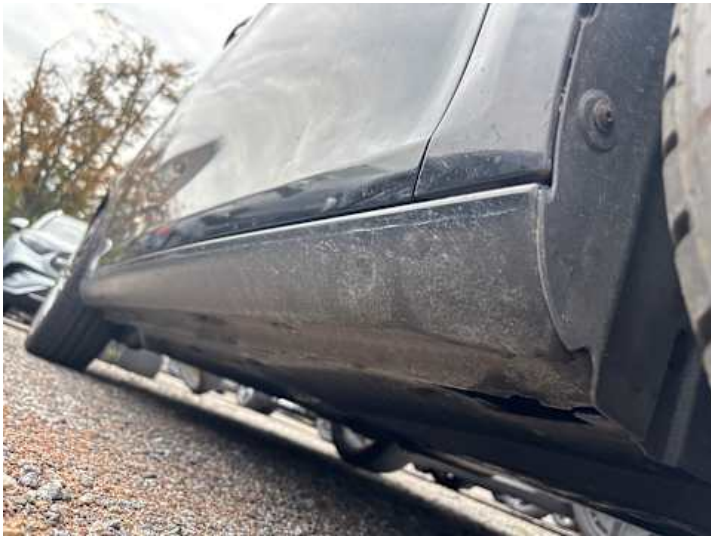
Schweller rechts (Verformung)
