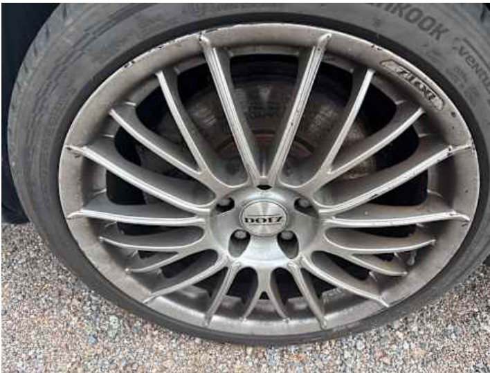
Rad (Kerben, Rost)
