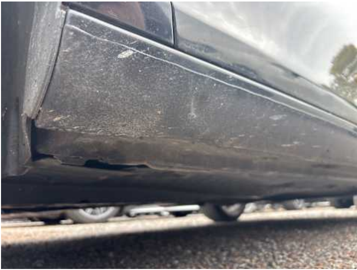
Schweller links (Verformung)
