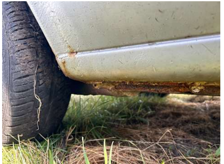
Schweller rechts (Rost)
