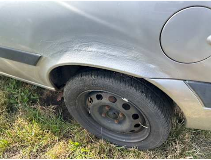
Seitenteil hinten links (Kratzer, Rost, Unsachgemäß instand gesetzt)
