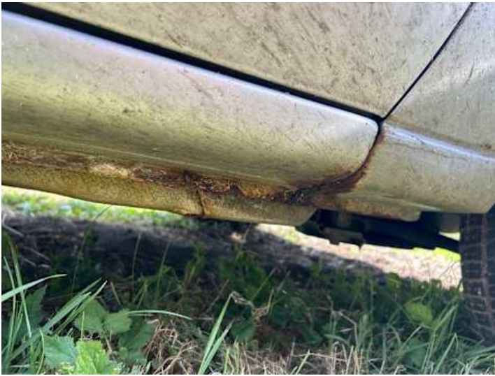
Schweller rechts (Rost)
