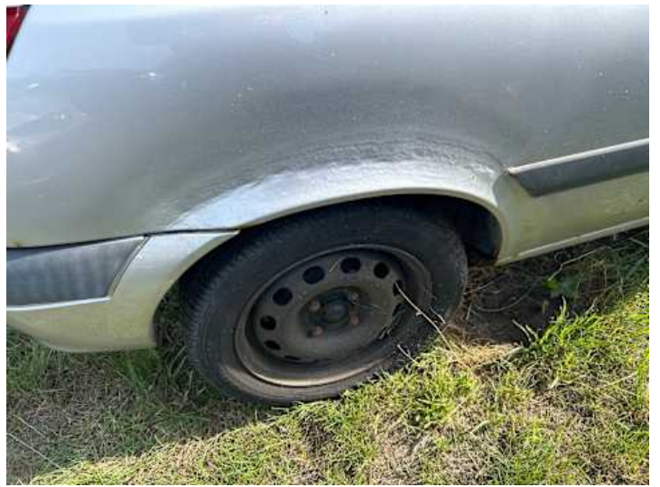
Seitenteil hinten rechts (Unsachgemäß instand gesetzt, Lackschaden)
