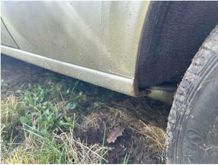
Seitenteil hinten links (Kratzer, Rost, Unsachgemäß instand gesetzt)
