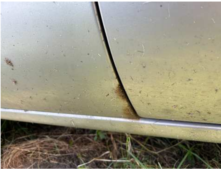
Seitenteil hinten rechts (Kratzer, Rost)
