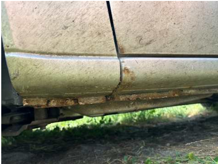
Schweller links (Rost)
