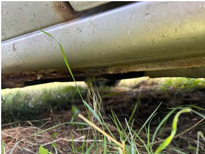
Schweller rechts (Rost)
