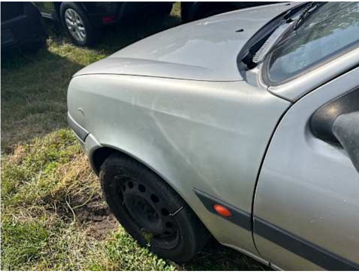
Kotflügel vorne links (Kratzer, Ausgeblichen/Matt)
