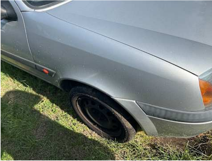
Kotflügel vorne rechts (Rost, Kratzer)
