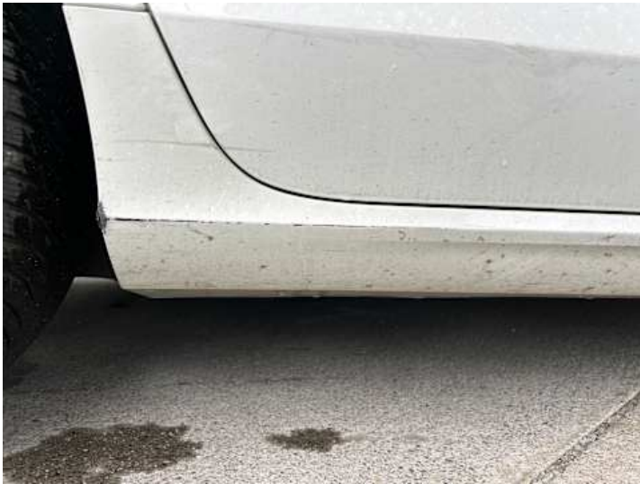
Schweller rechts (Kratzer)
