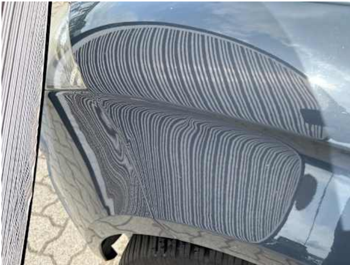
Kotflügel vorne links (Delle, Verformung)
