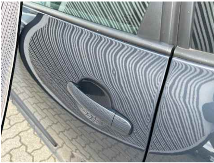
Türe hinten links (Delle, Kratzer)
