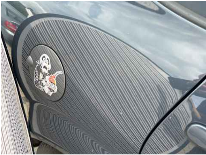
Seitenteil hinten rechts (Delle)
