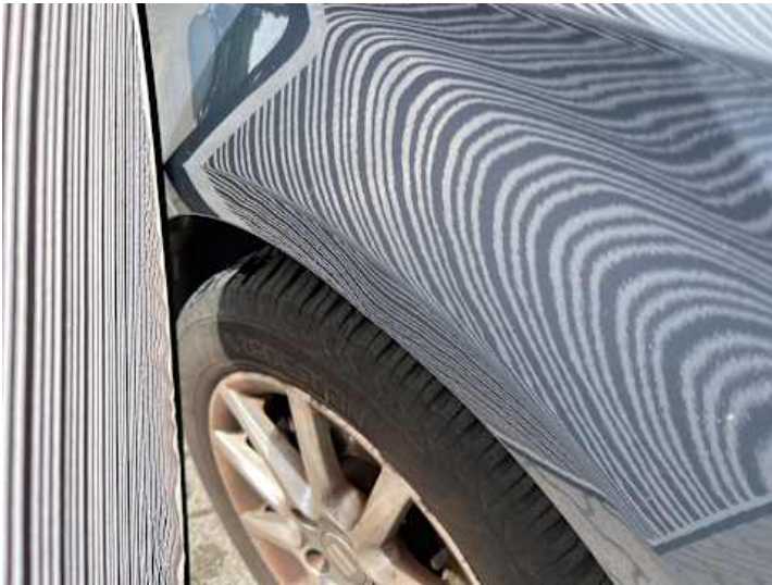
Kotflügel vorne links (Delle, Verformung)
