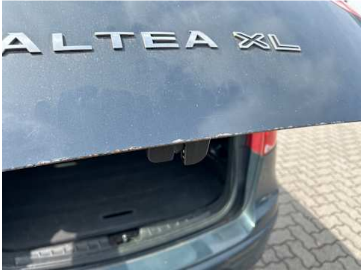
Heckklappe (Delle, Kratzer, Lackschaden)
