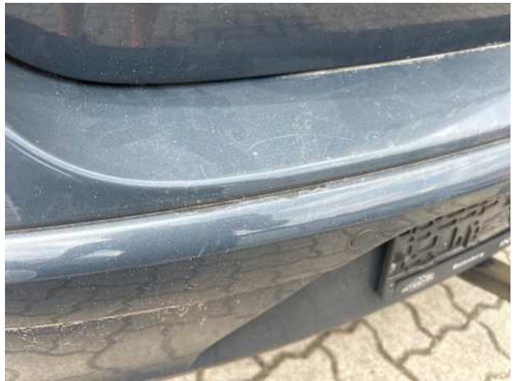
Stoßstange hinten (Kratzer, Lackschaden)
