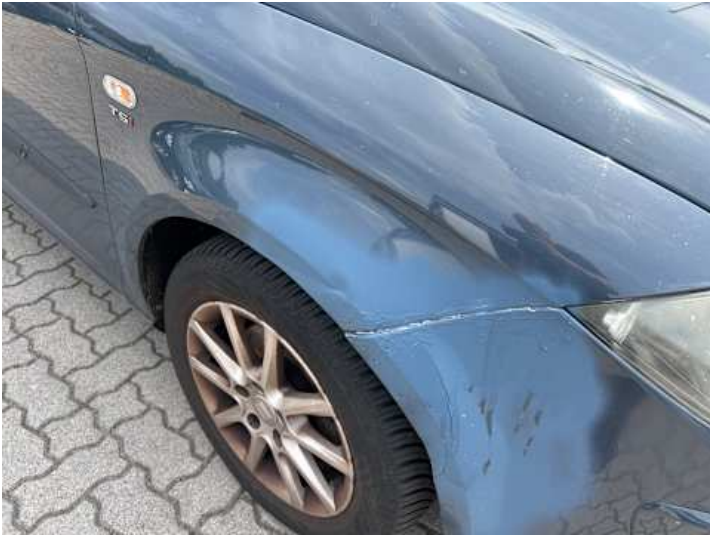
Kotflügel vorne rechts (Verformung, Unsachgemäß instand gesetzt, Lackschaden)
