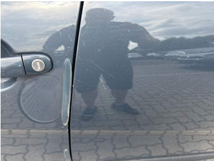
Türe hinten links (Delle, Kratzer)
