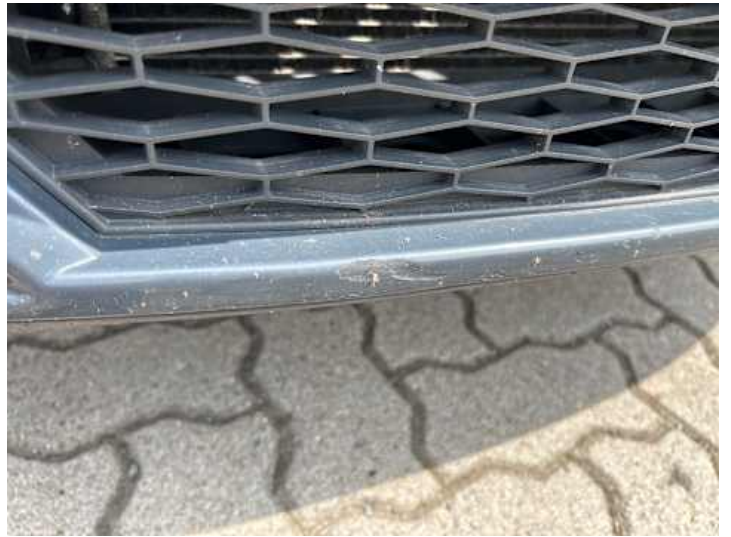
Stoßstange vorne (Kratzer, Lackschaden, Unsachgemäß instand gesetzt, Verformung)
