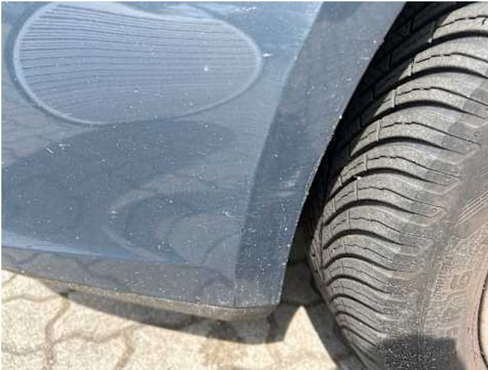
Stoßstange vorne (Kratzer, Lackschaden, Unsachgemäß instand gesetzt, Verformung)
