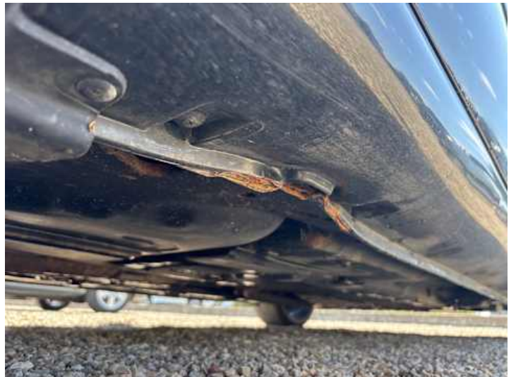
Schweller rechts (Verformung, Lackschaden, Rost)
