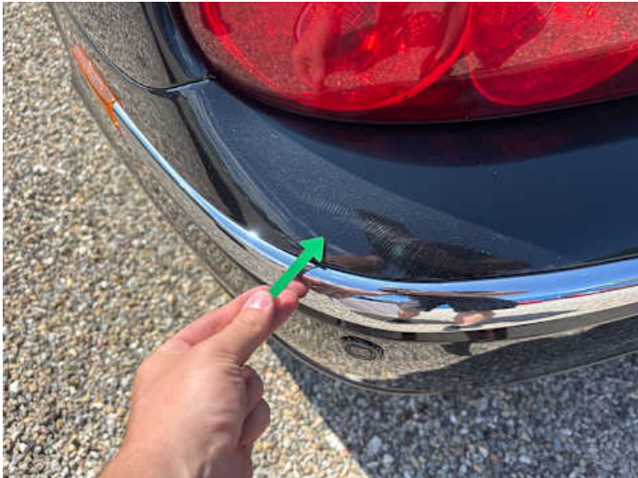
Stoßstange hinten (Kratzer, Lackschaden)
