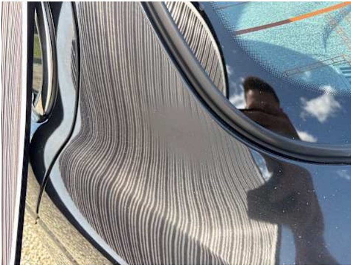
Seitenteil hinten links (Lackschaden, Ausgeblichen/Matt)
