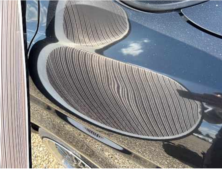
Seitenteil hinten links (Delle)
