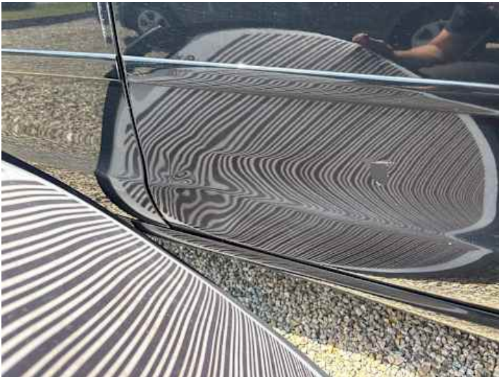
Türe hinten links (Lackschaden, Verformung)
