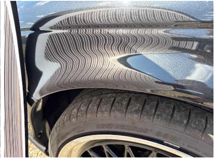
Kotflügel vorne links (Kratzer, Lackschaden, Unsachgemäß instand gesetzt, Ausgeblichen/Matt, Rost)
