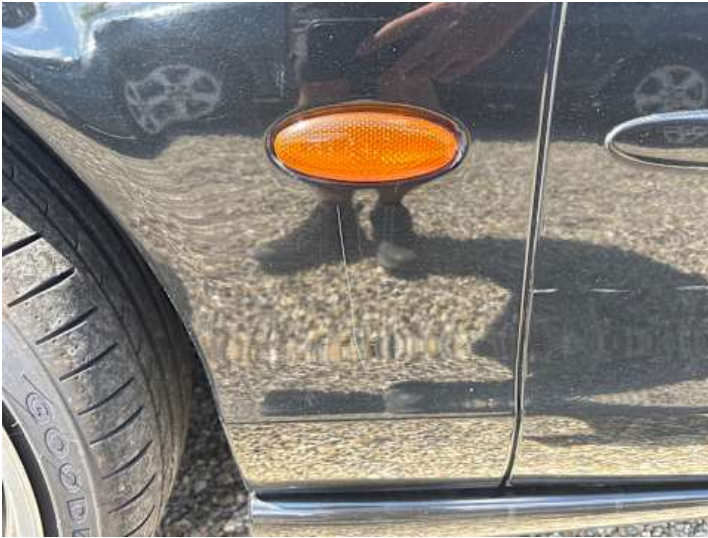
Kotflügel vorne links (Kratzer, Lackschaden, Unsachgemäß instand gesetzt, Ausgeblichen/Matt, Rost)
