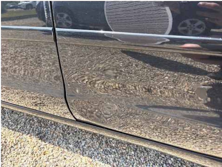
Türe hinten links (Lackschaden, Verformung)
