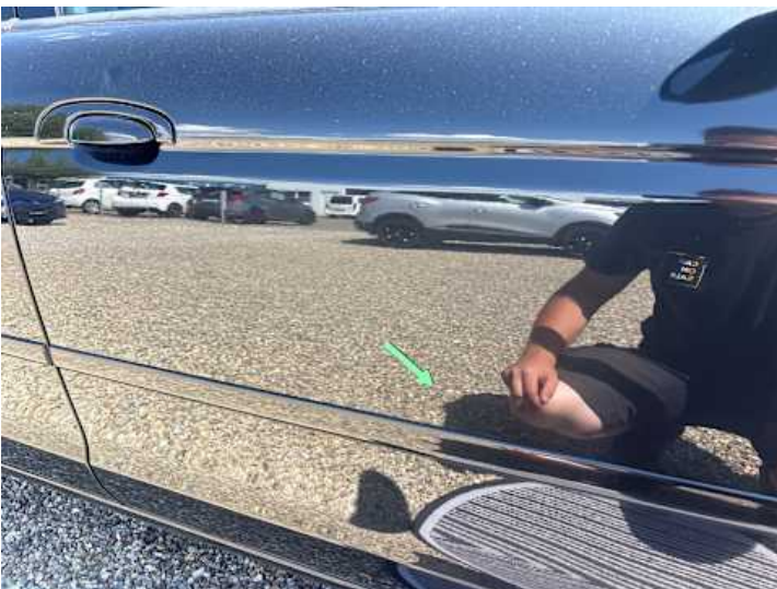
Beifahrertür (Kratzer, Lackschaden)
