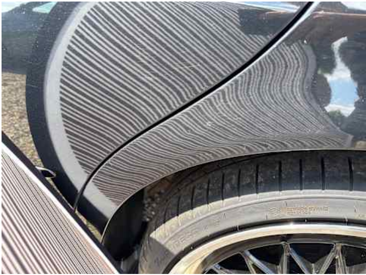
Seitenteil hinten links (Delle)
