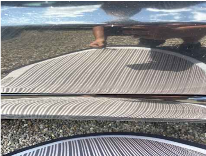
Türe hinten links (Lackschaden, Verformung)
