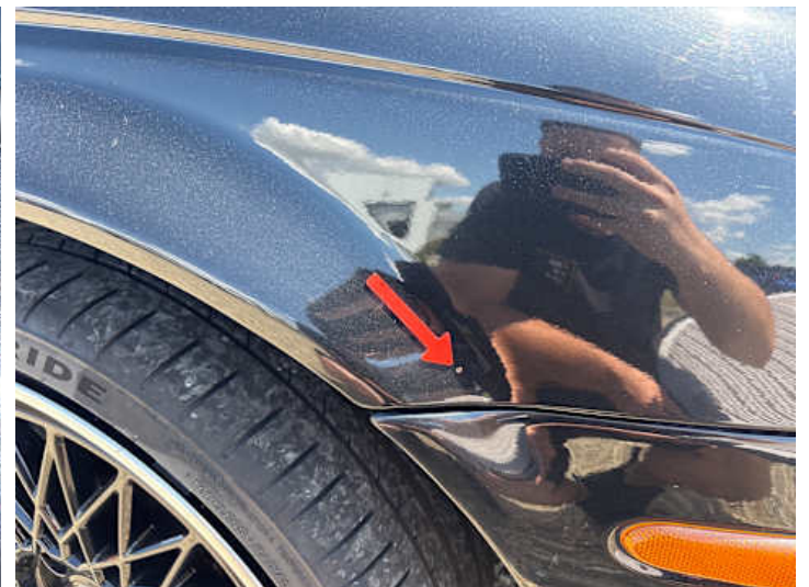
Kotflügel vorne rechts (Lackschaden, Rost)
