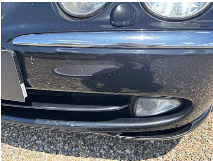
Stoßstange vorne (Steinschlag, Unsachgemäß instand gesetzt)
