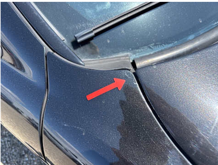
Kotflügel vorne rechts (Lackschaden, Rost)
