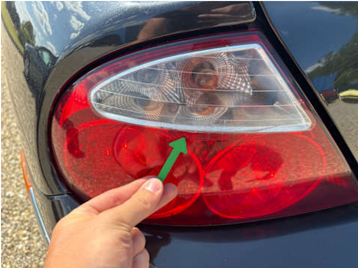
Rücklicht (links) (Riss/Bruch)
