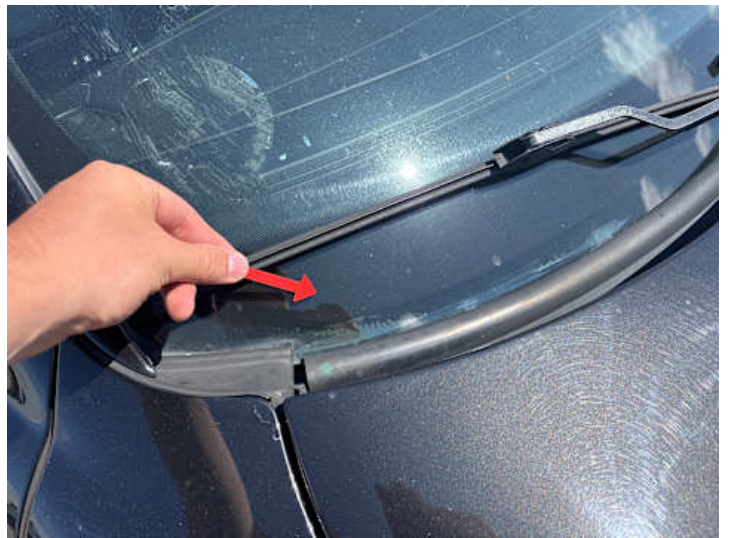
Windschutzscheibe (Anderer Schaden): Ablösung
