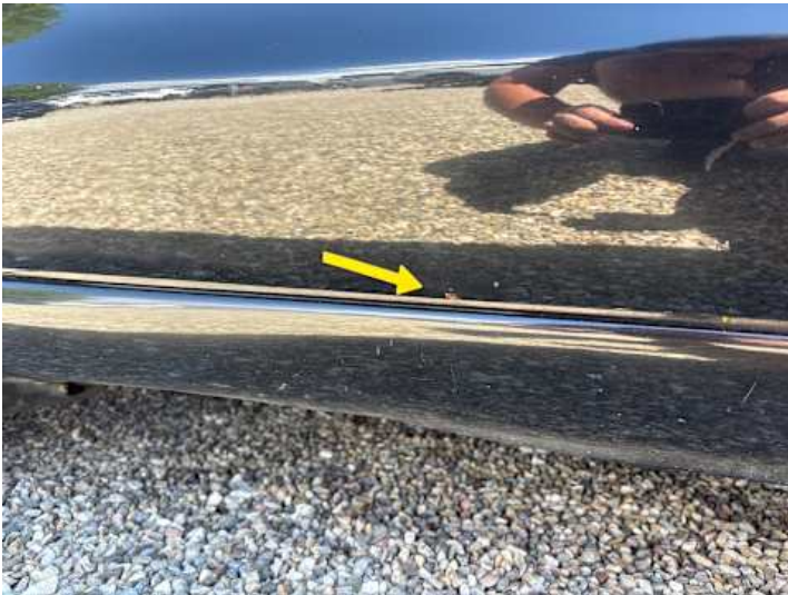
Türe hinten rechts (Kratzer, Lackschaden, Rost, Unsachgemäß instand gesetzt, Ausgeblichen/Matt)
