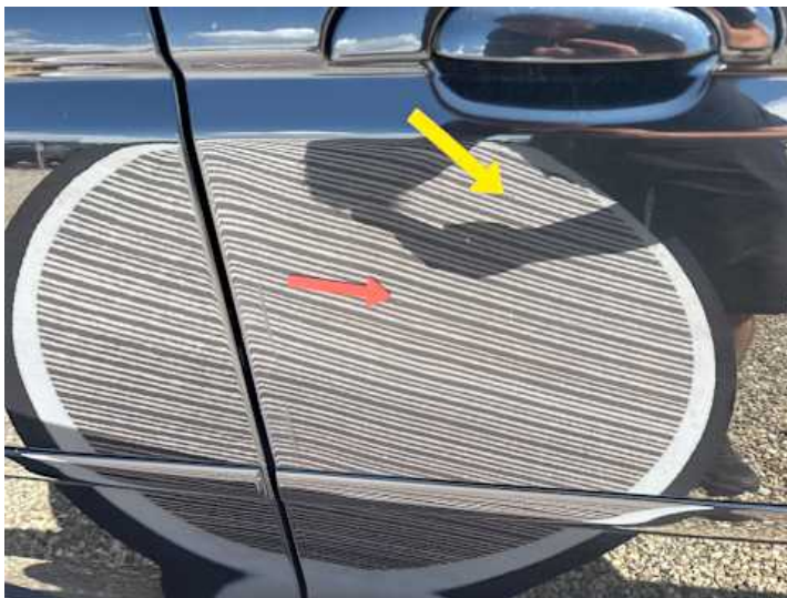
Beifahrertür (Delle, Kratzer)
