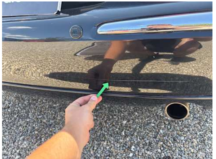
Stoßstange hinten (Kratzer, Lackschaden)
