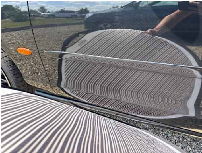
Fahrrertür (Kratzer, Lackschaden)
