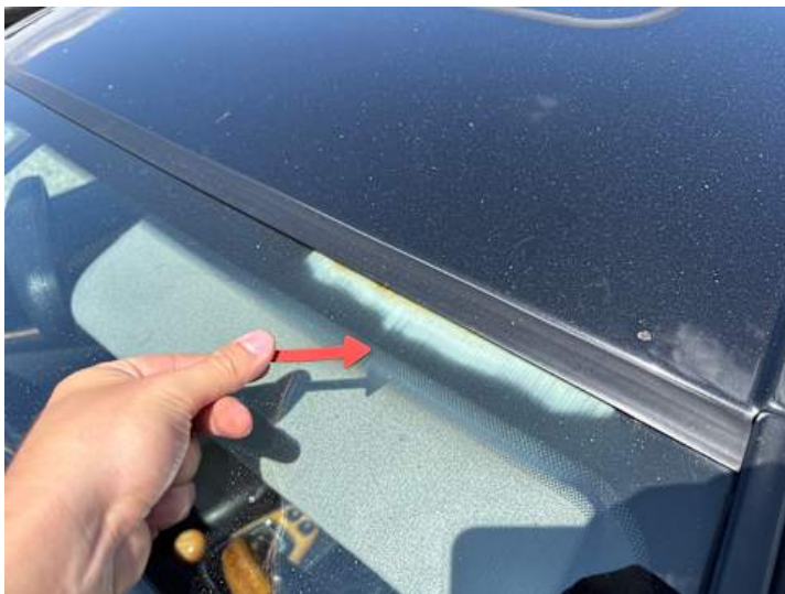
Windschutzscheibe (Anderer Schaden): Ablösung
