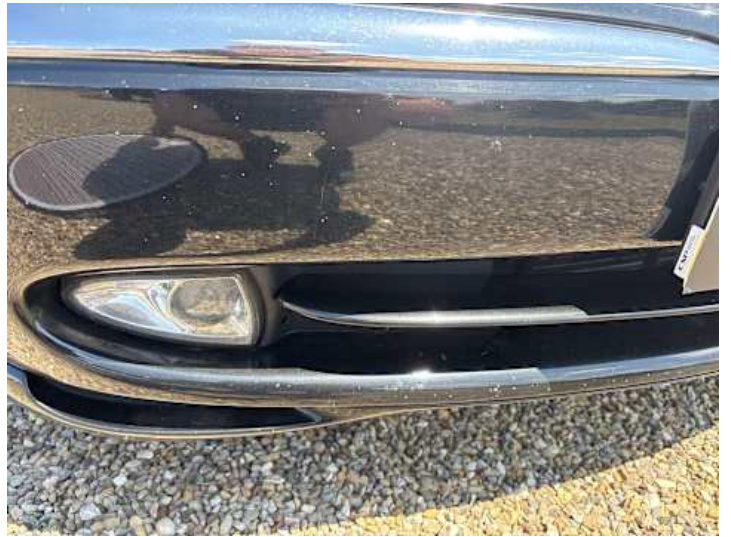
Stoßstange vorne (Steinschlag, Unsachgemäß instand gesetzt)
