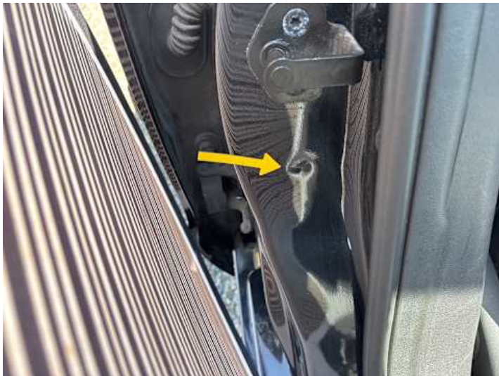
Schweller rechts (Kratzer, Delle)
