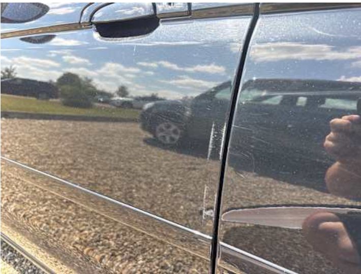
Fahrrertür (Kratzer, Lackschaden)
