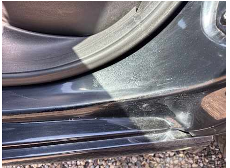
Schweller links (Lackschaden, Rost, Kratzer)
