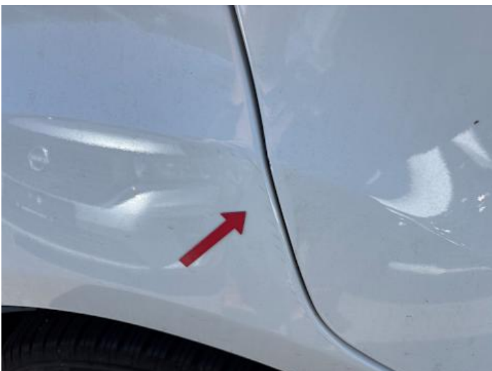
Seitenteil hinten rechts (Kratzer)
