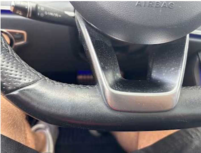
Innenraum (Kratzer, Verschleiß)
