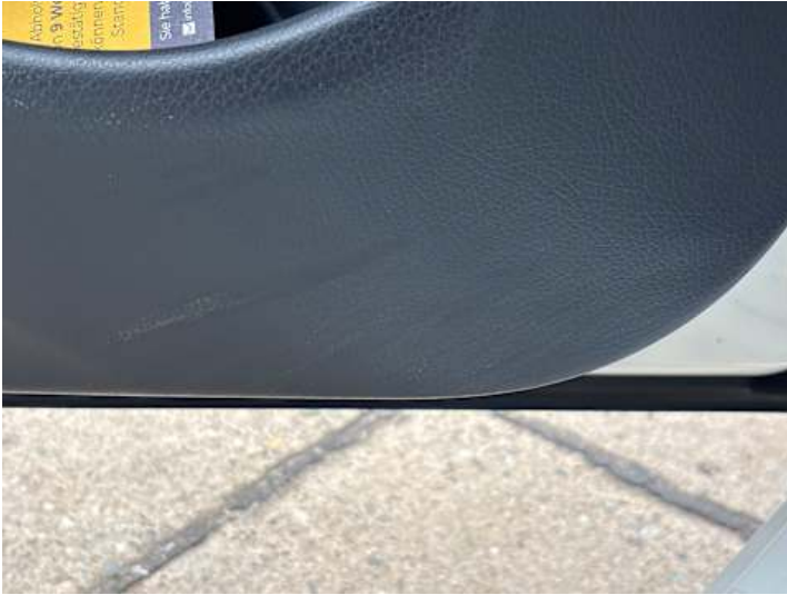
Innenraum (Kratzer, Verschleiß)
