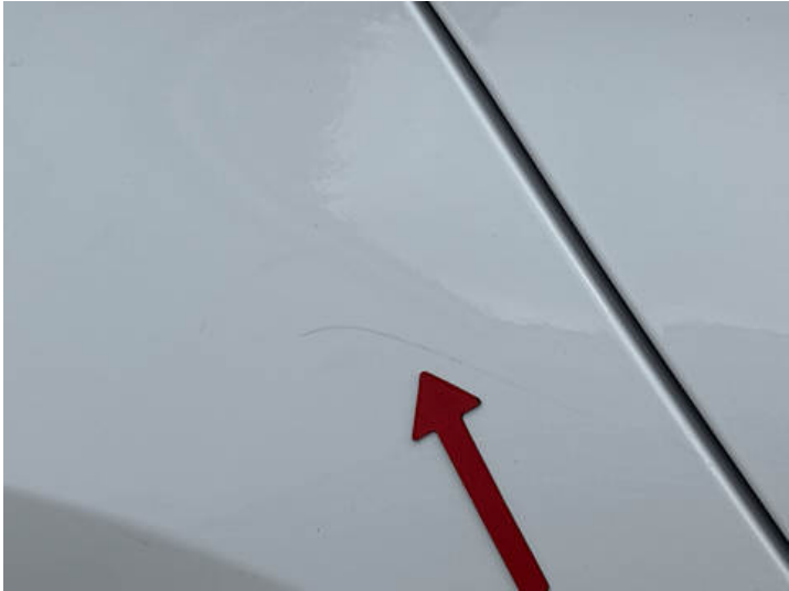
Seitenteil hinten rechts (Kratzer, Lackschaden)
