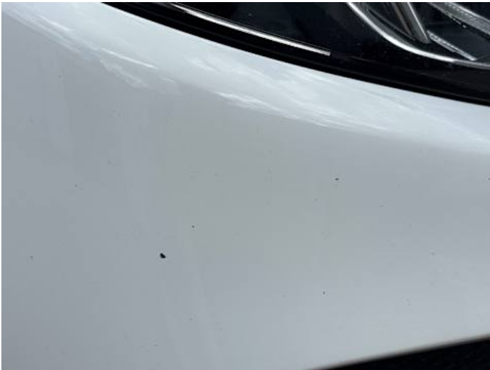
Stoßstange vorne (Lackschaden, Steinschlag)
