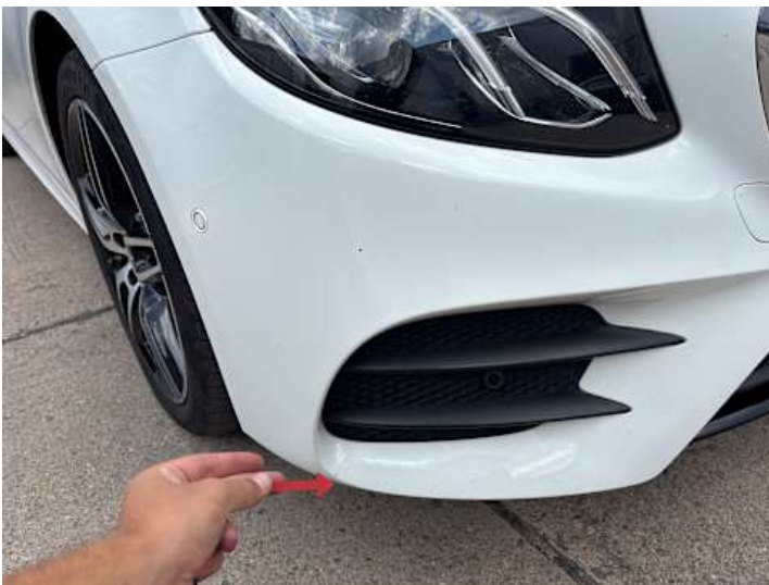
Stoßstange vorne (Lackschaden, Steinschlag)
