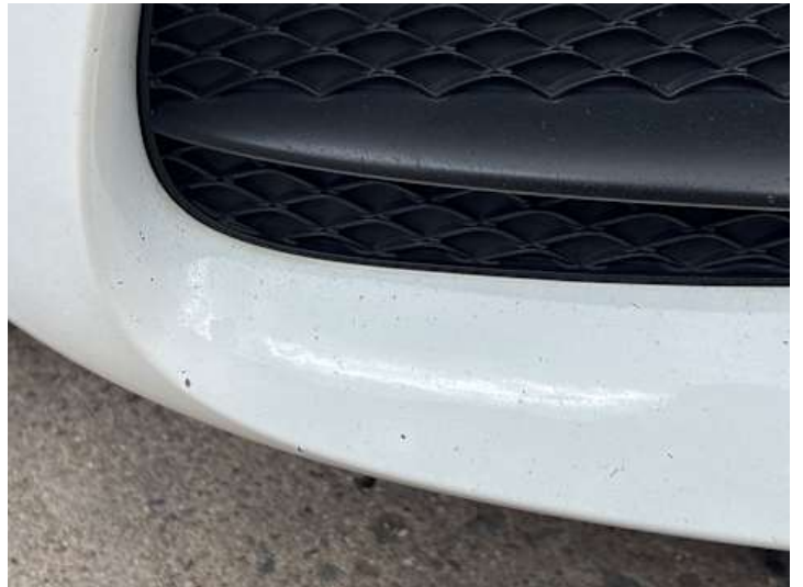
Stoßstange vorne (Lackschaden, Steinschlag)
