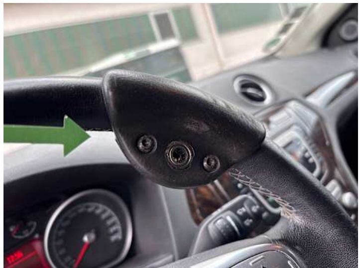
Innenraum (Anderer Schaden): Behindertengerechter Umbau
