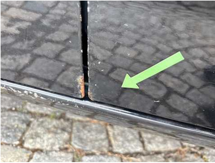
Türe hinten links (Rost)
