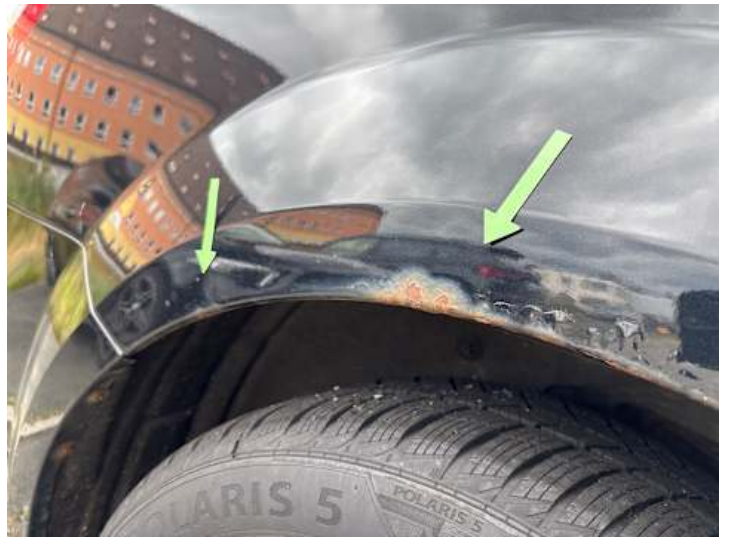
Seitenteil hinten rechts (Rost)
