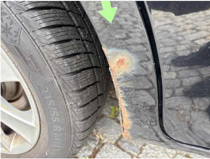
Seitenteil hinten rechts (Rost)
