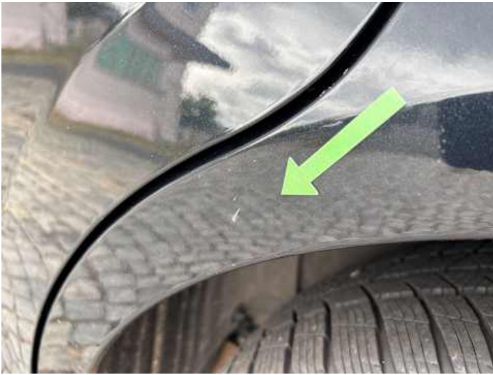
Seitenteil hinten links (Rost)
