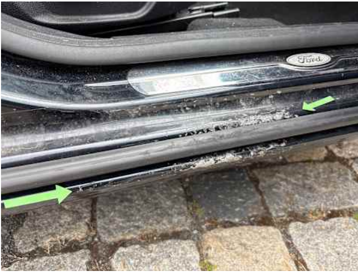
Schweller rechts (Rost, Lackschaden)
