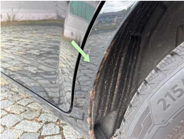
Seitenteil hinten links (Rost)
