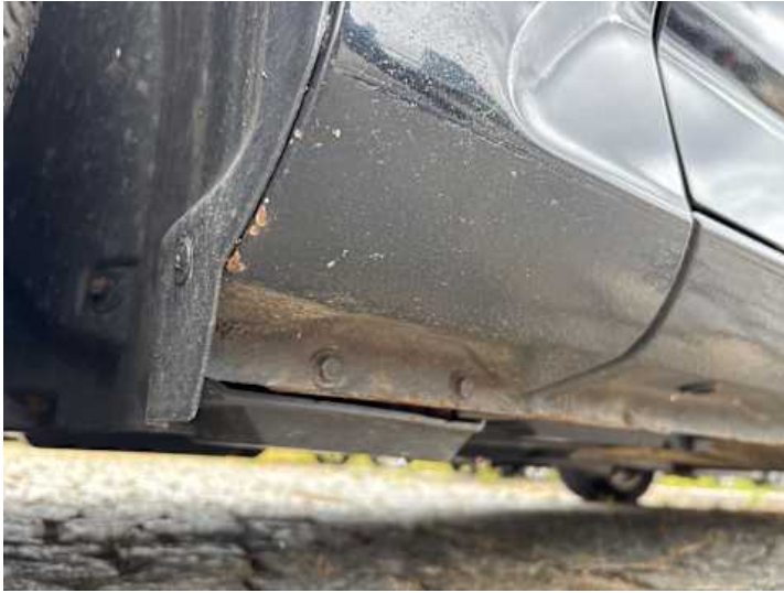
Schweller links (Rost, Lackschaden)
