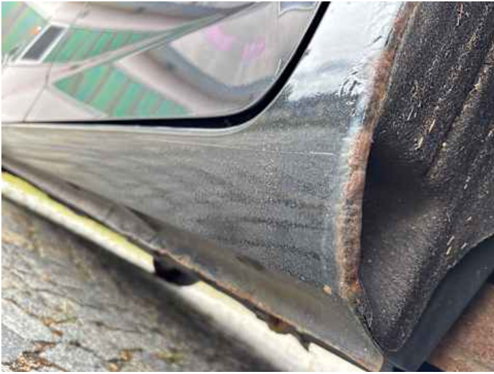
Schweller links (Rost, Lackschaden)
