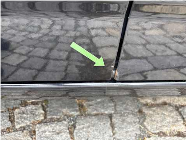
Türe hinten rechts (Rost)
