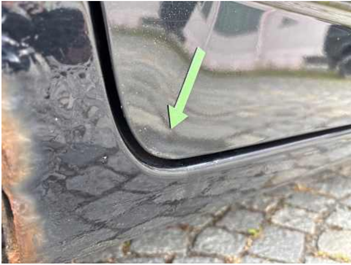
Türe hinten rechts (Rost)
