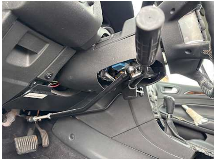
Innenraum (Anderer Schaden): Behindertengerechter Umbau
