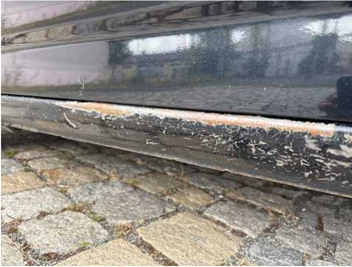
Schweller links (Rost, Lackschaden)
