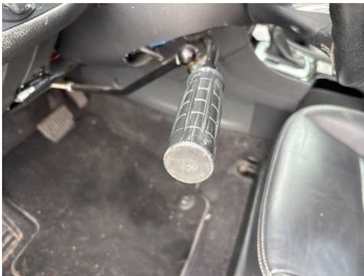
Innenraum (Anderer Schaden): Behindertengerechter Umbau
