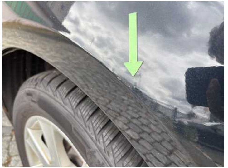
Seitenteil hinten links (Rost)
