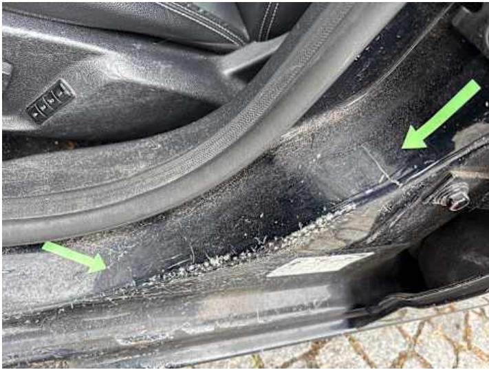
Schweller links (Lackschaden, Delle)
