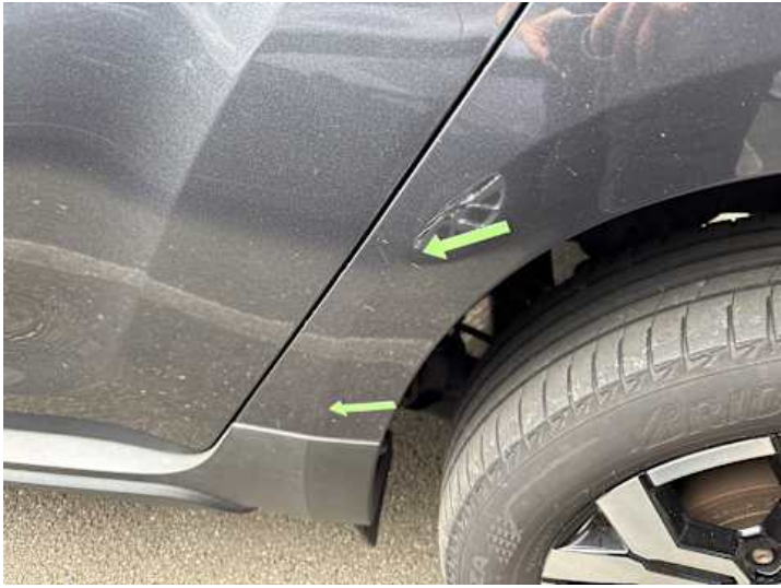
Seitenteil hinten links (Kratzer, Delle)
