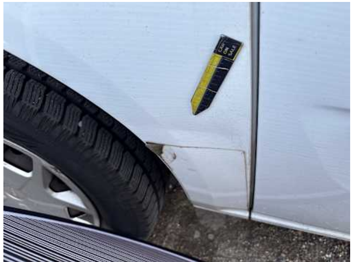
Seitenteil hinten rechts (Verformung)
