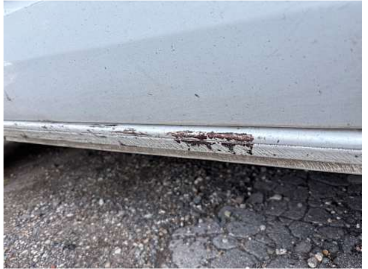
Schweller rechts (Kratzer, Rost, Lackschaden)
