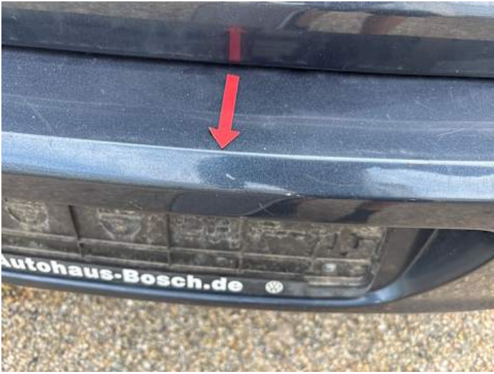
Stoßstange hinten (Delle, Kratzer)
