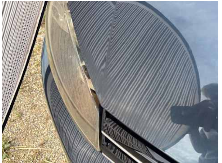
Motorhaube (Ausgeblichen/Matt, Steinschlag, Rost)
