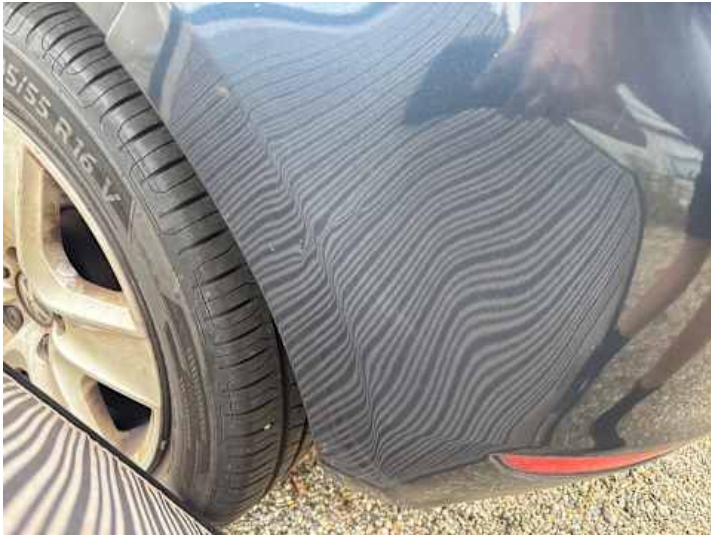
Stoßstange hinten (Delle, Kratzer)
