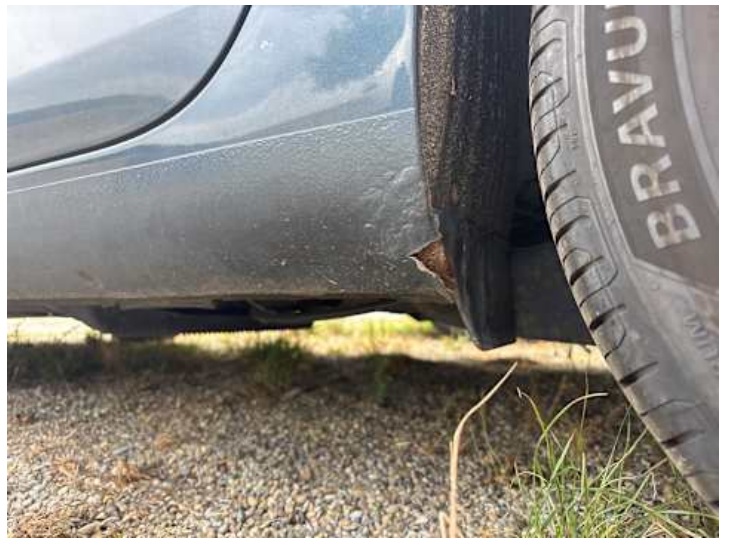
Schweller links (Rost)
