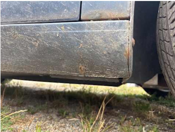
Schweller rechts (Rost)
