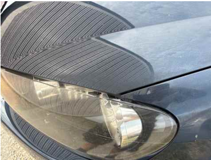
Motorhaube (Ausgeblichen/Matt, Steinschlag, Rost)
