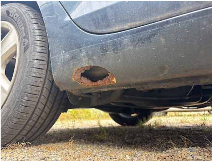
Schweller rechts (Rost)
