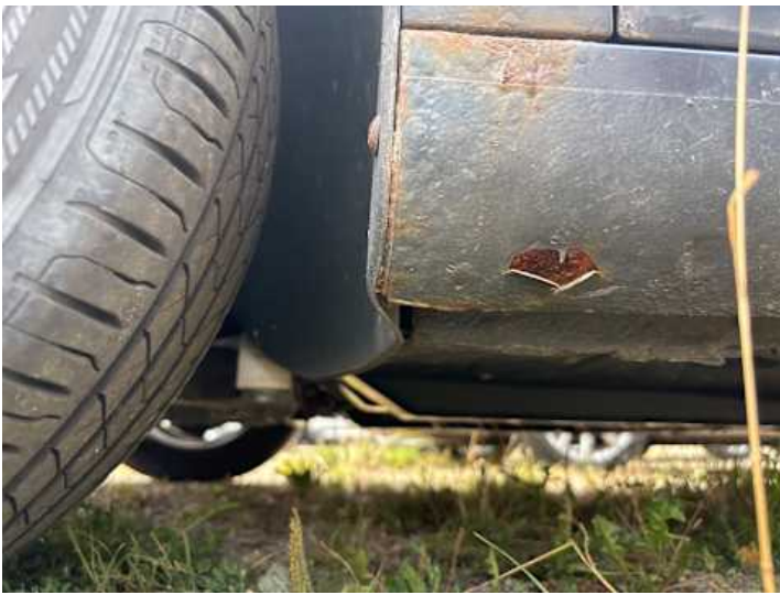
Schweller links (Rost)
