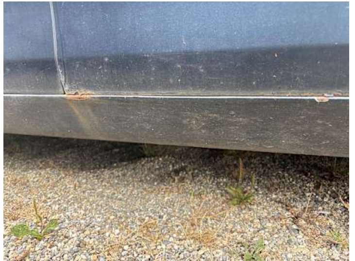
Schweller rechts (Rost)
