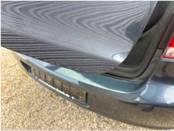
Heckklappe (Rost, Ausgeblichen/Matt)
