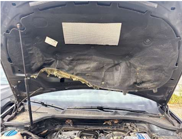
Motorhaube (Anderer Schaden): Dämmmatte angefressen
