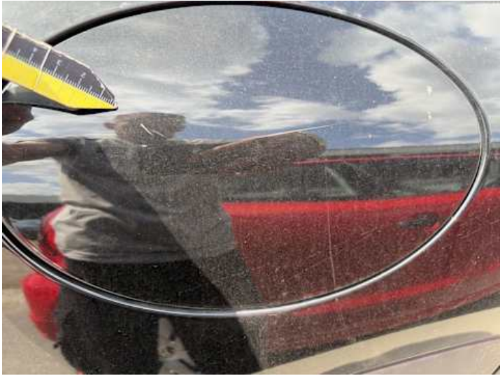
Seitenteil hinten rechts (Lackschaden, Kratzer)
