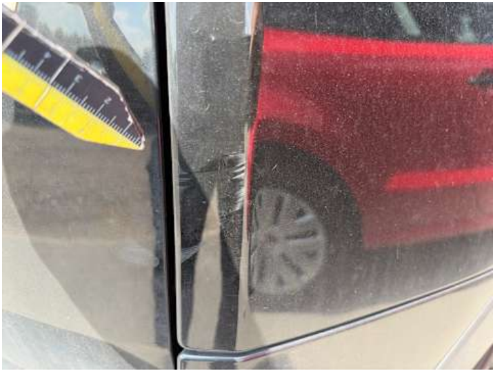
Seitenteil hinten rechts (Lackschaden, Kratzer)
