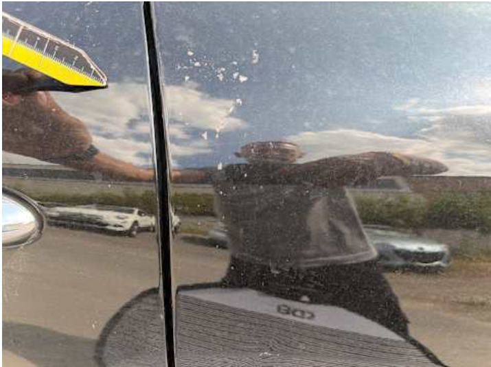
Seitenteil hinten links (Lackschaden, Kratzer)
