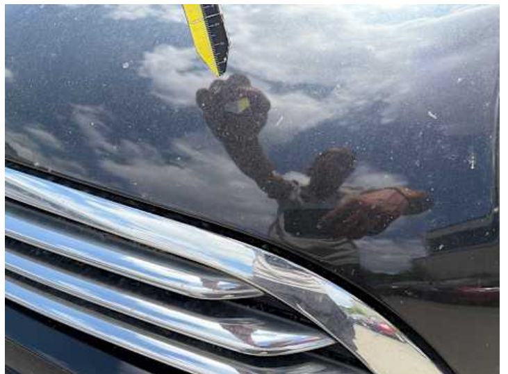
Motorhaube (Lackschaden, Kratzer, Steinschlag)
