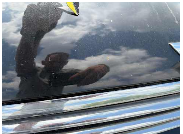
Motorhaube (Lackschaden, Kratzer, Steinschlag)
