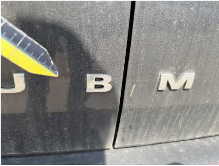
Heckklappe (Lackschaden, Kratzer)
