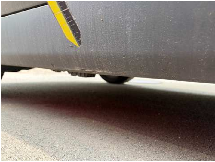
Schweller rechts (Lackschaden, Kratzer, Verformung)
