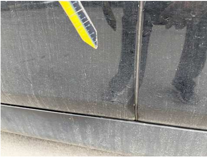
Fahrentür (Lackschaden, Kratzer)
