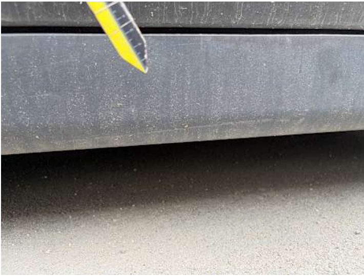
Schweller links (Lackschaden, Kratzer)
