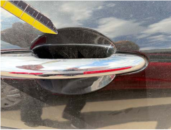
Türe hinten rechts (Lackschaden, Kratzer)
