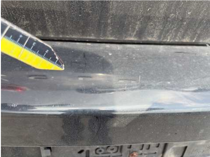
Stoßstange hinten (Lackschaden, Kratzer)
