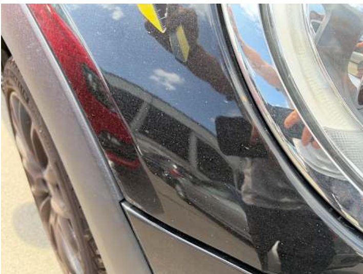
Motorhaube (Lackschaden, Kratzer, Steinschlag)
