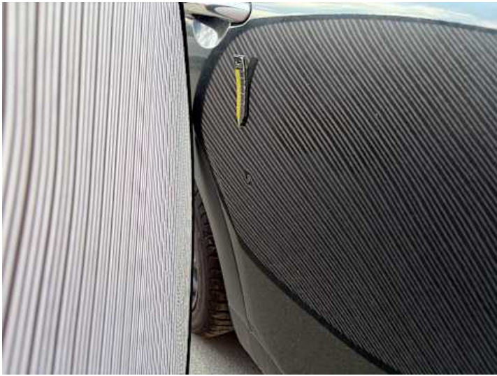
Türe hinten rechts (Delle)
