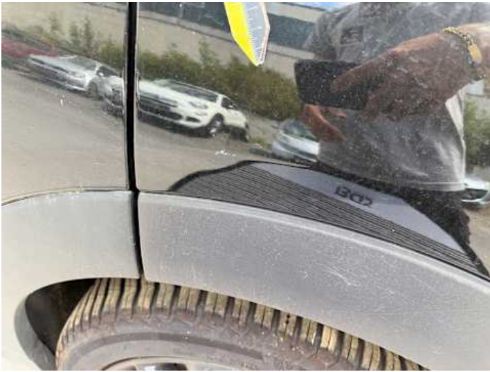
Seitenteil hinten links (Lackschaden, Kratzer)
