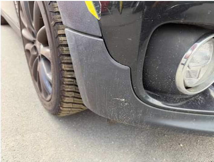
Stoßstange vorne (Lackschaden, Kratzer)
