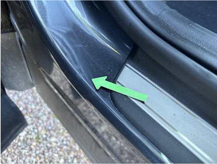
Schweller links (Lackschaden)
