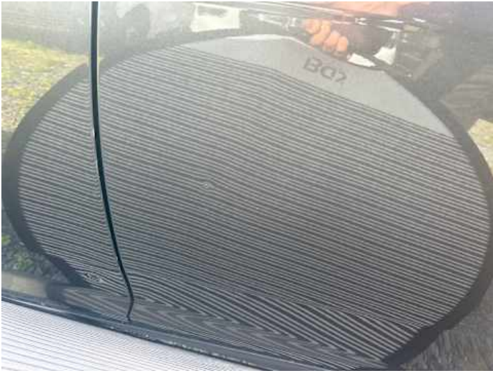
Türe hinten links (Delle)
