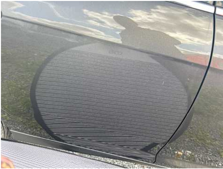
Türe hinten rechts (Delle)
