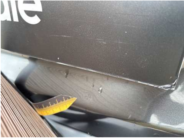
Heckklappe (Delle, Verformung)
