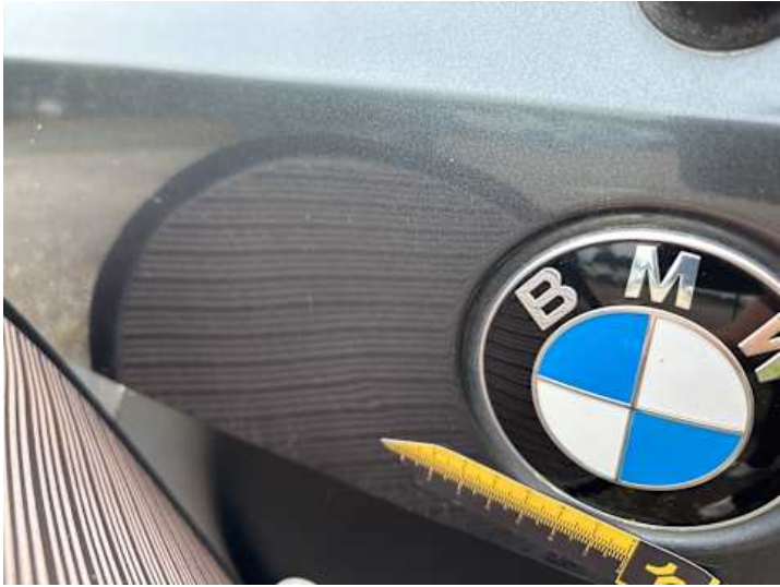
Heckklappe (Delle, Verformung)
