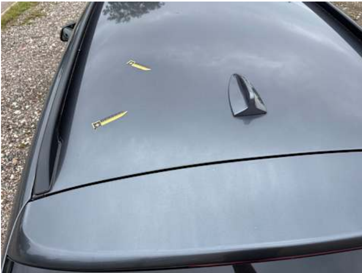
Dach (Delle, Verformung)
