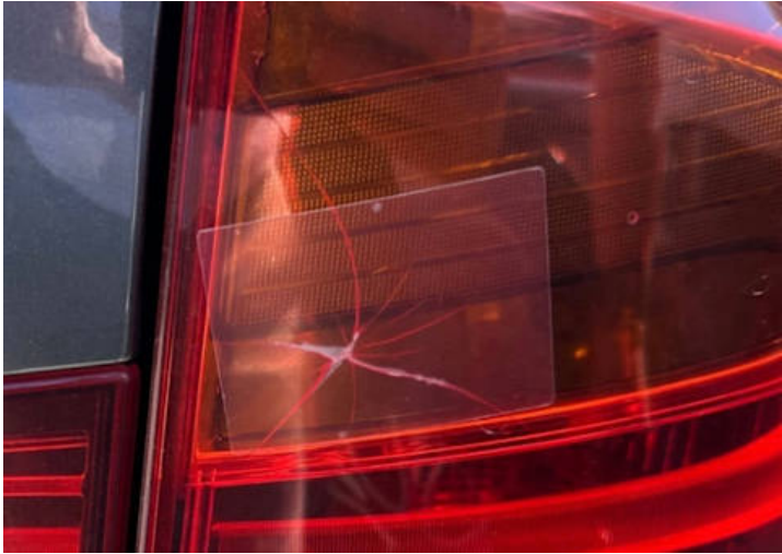
Rücklicht (rechts) (Kratzer, Riss/Bruch)
