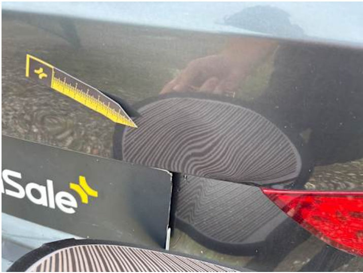
Heckklappe (Delle, Verformung)
