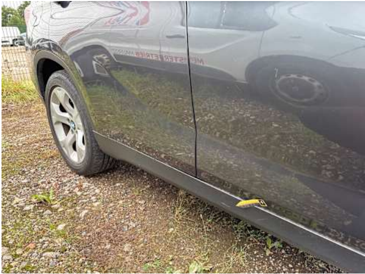
Schweller rechts (Kratzer)
