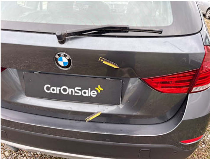
Heckklappe (Delle, Verformung)
