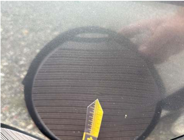
Türe hinten links (Delle)
