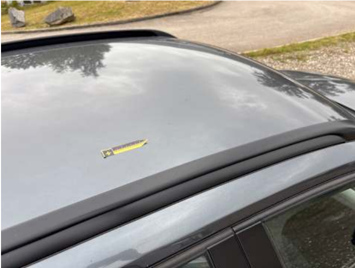
Dach (Delle, Verformung)
