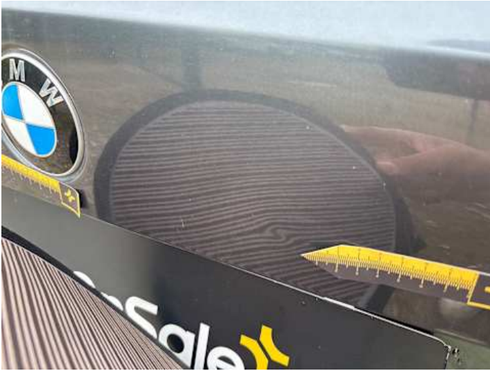
Heckklappe (Delle, Verformung)
