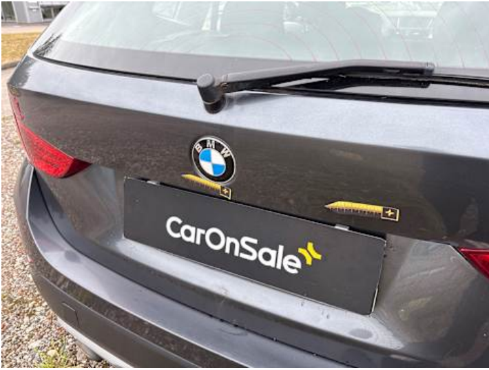
Heckklappe (Delle, Verformung)
