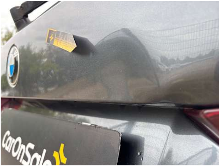
Heckklappe (Delle, Verformung)
