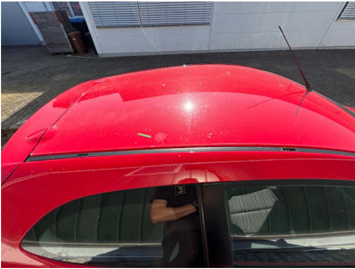
Dach (Delle, Lackschaden, Ausgeblichen/Matt)
