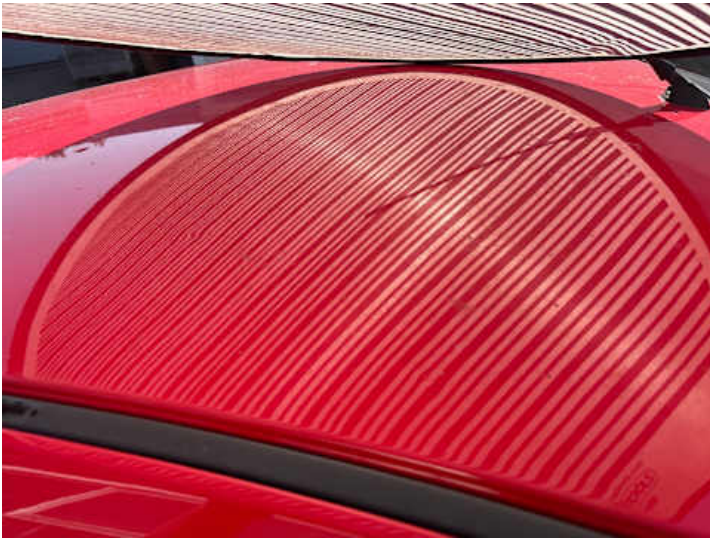
Dach (Delle, Lackschaden, Ausgeblichen/Matt)
