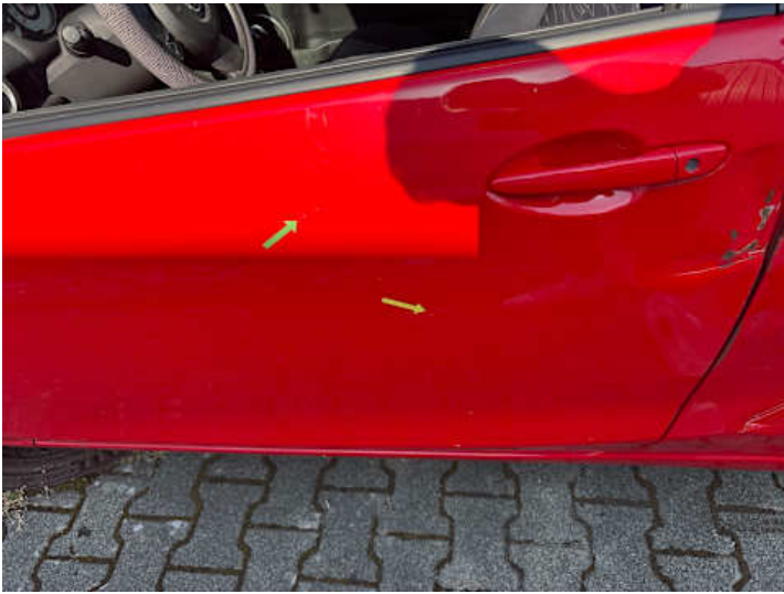
Fahrtür (Delle, Kratzer)
