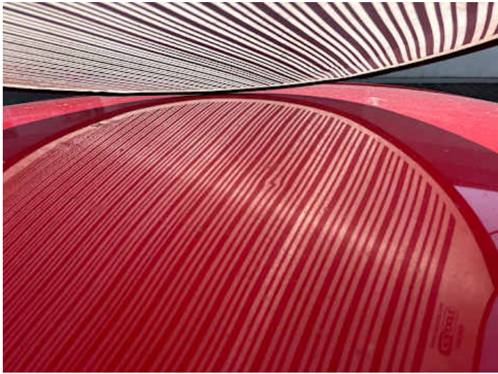
Dach (Delle, Lackschaden, Ausgeblichen/Matt)
