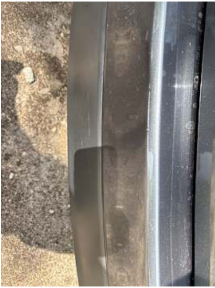
Stoßstange hinten (Delle, Kratzer, Lackschaden)
