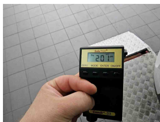
Lackstärke Seitenwand hinten rechts
