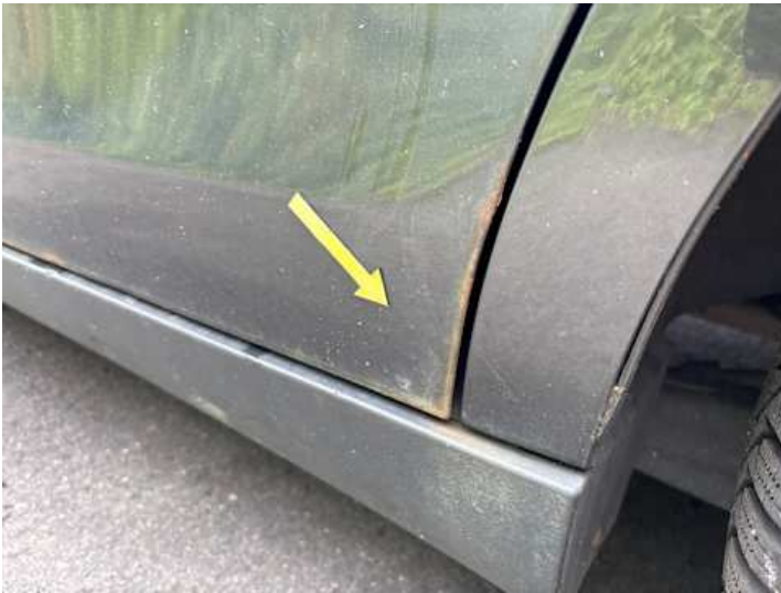
Türe hinten links (Rost)
