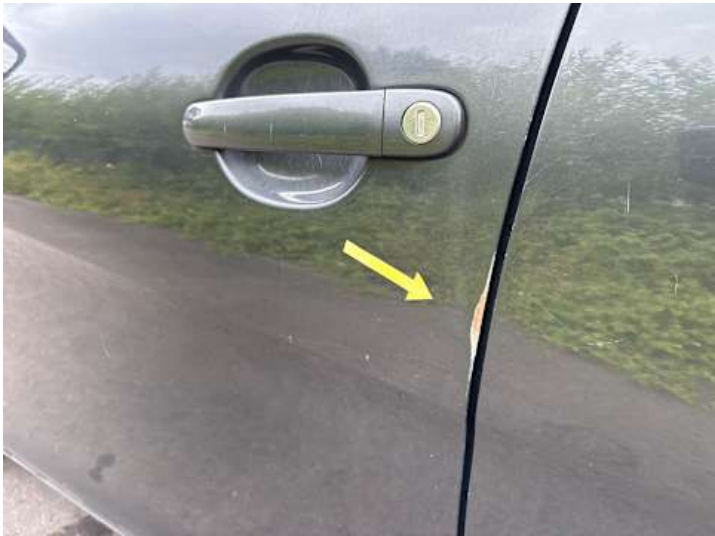
Fahrtür (Rost, Lackschaden)
