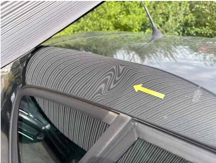
Seitenteil hinten rechts (Delle, Verformung)
