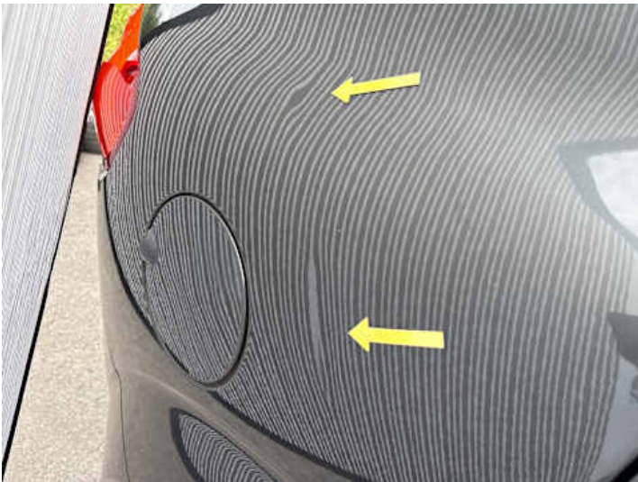
Seitenteil hinten rechts (Verformung, Delle)
