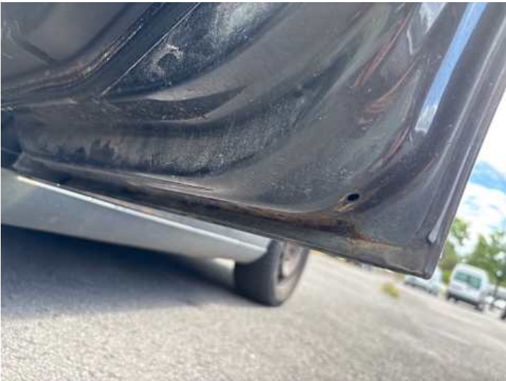
Türe hinten rechts (Rost)
