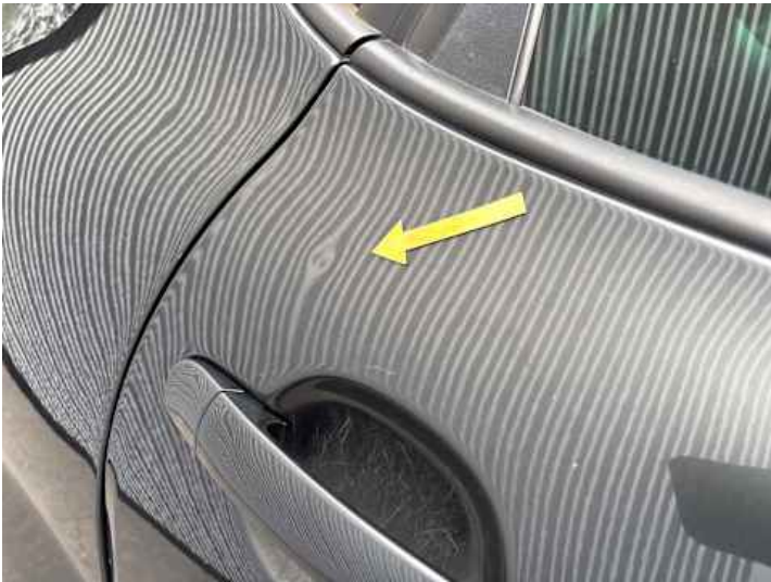
Türe hinten rechts (Delle)
