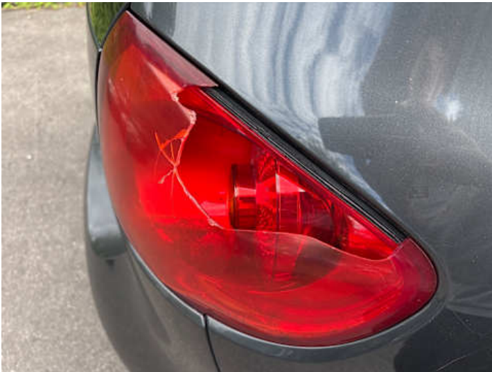
Rücklicht (rechts) (Riss/Bruch)
