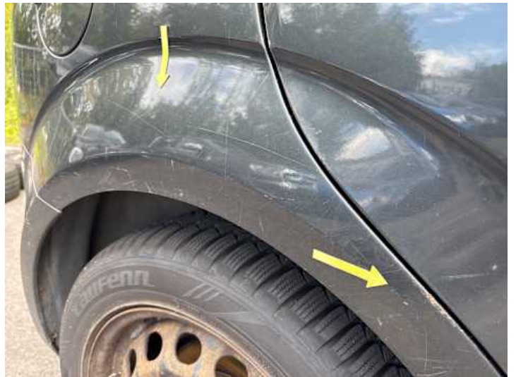
Seitenteil hinten rechts (Rost, Kratzer)
