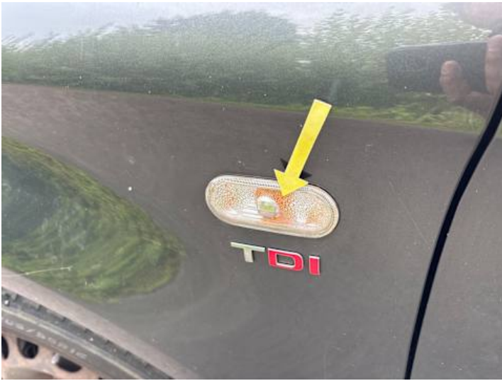
Kotflügel vorne links (Anderer Schaden): Undicht
