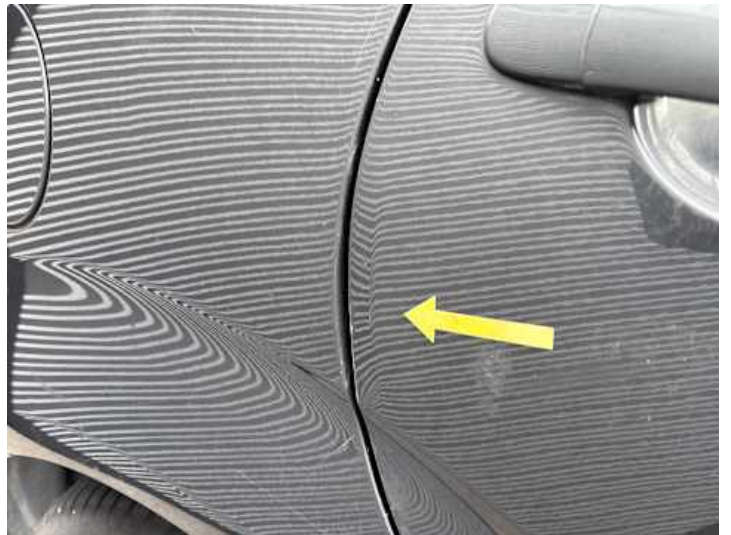
Türe hinten rechts (Verformung)
