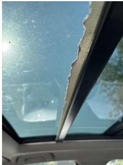
Innenraum (Anderer Schaden): Schiebedach Dämmung gerissen
