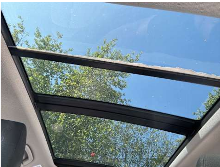
Innenraum (Anderer Schaden): Schiebedach Dämmung gerissen
