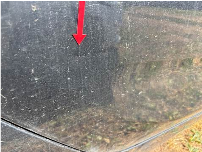
Türe hinten rechts (Delle, Kratzer)
