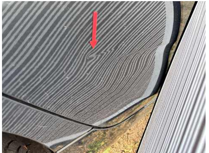
Türe hinten rechts (Delle, Kratzer)
