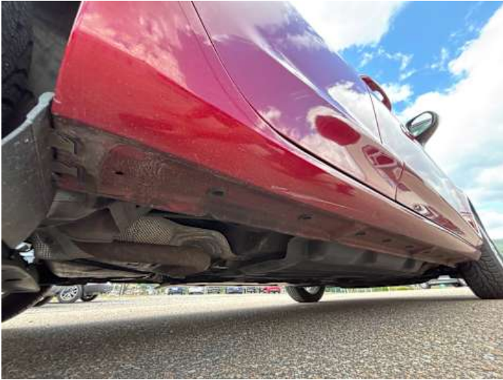
Schweller rechts (Kratzer, Lackschaden, Delle)
