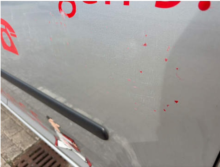
Türe hinten links (Lackschaden)
