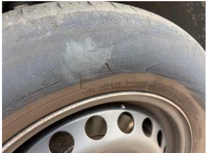
Rad (Anderer Schaden): Flanke beschädigt
