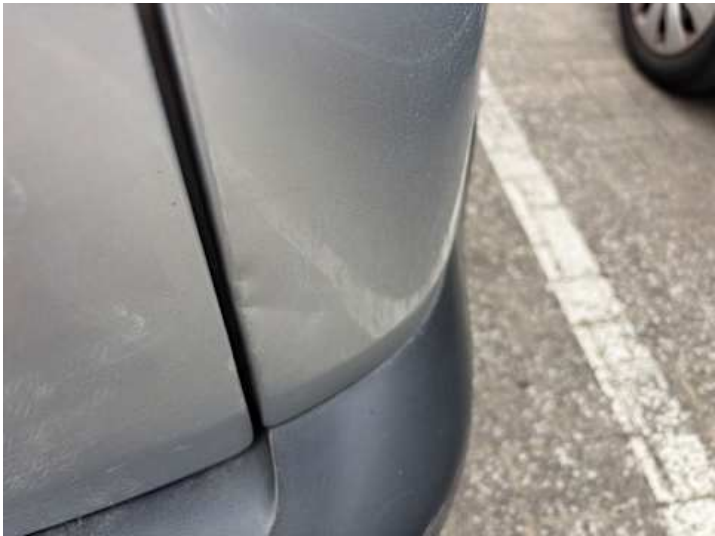
Seitenteil hinten rechts (Lackschaden, Delle)
