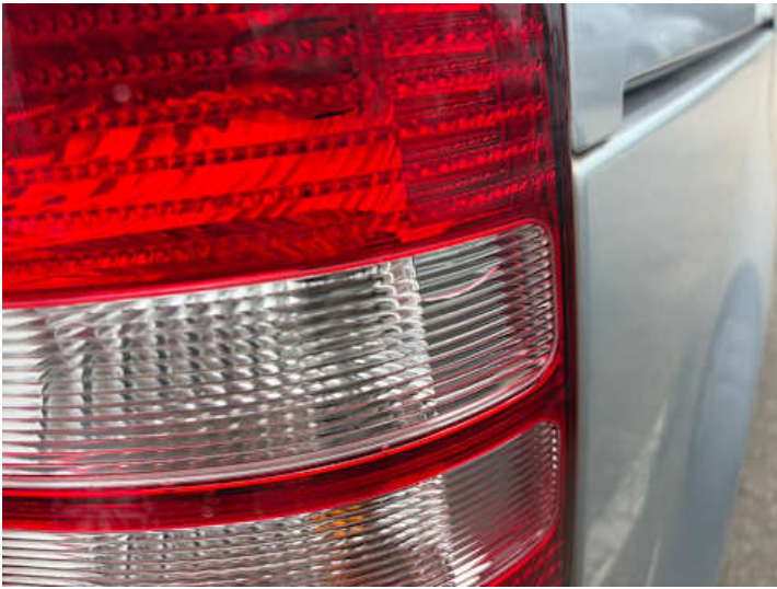
Rücklicht (rechts) (Riss/Bruch)
