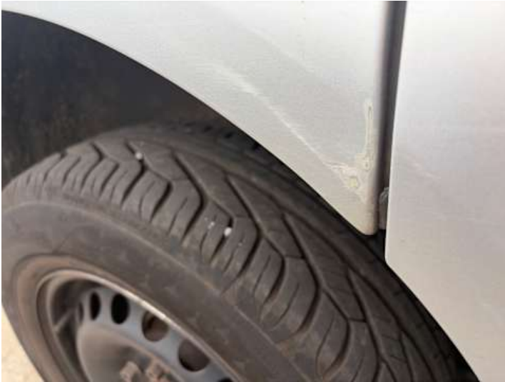
Seitenteil hinten rechts (Lackschaden, Delle)
