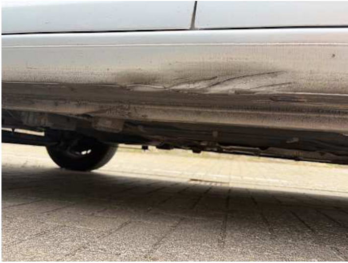
Schweller rechts (Delle, Lackschaden)
