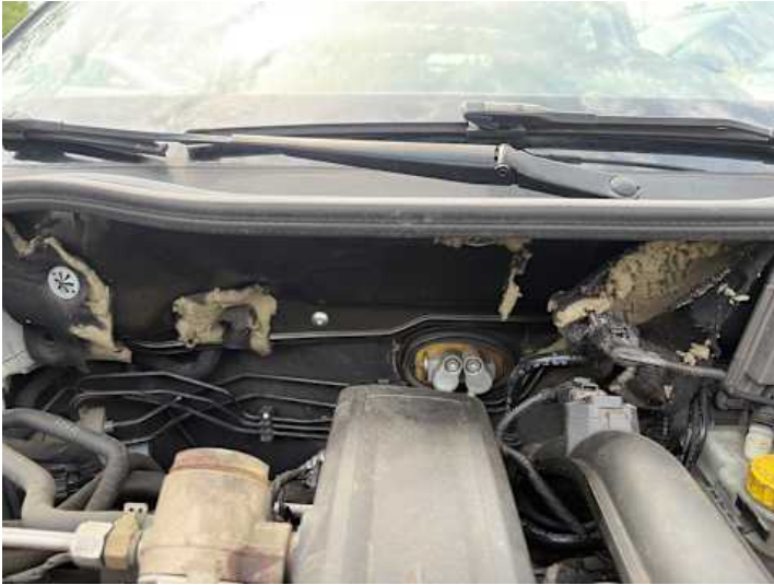
Motorhaube (Anderer Schaden): Dämmmatte beschädigt
