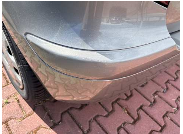
Stoßstange hinten (Lackschaden)
