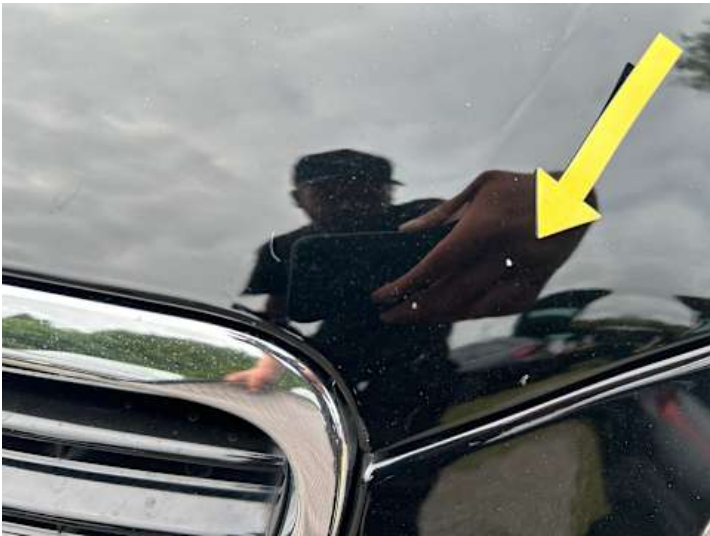
Motorhaube (Lackschaden, Steinschlag)
