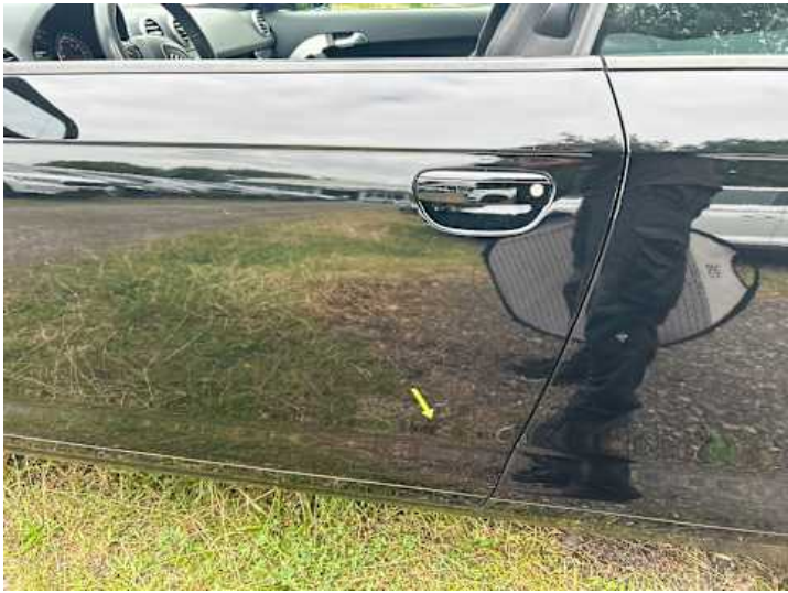
Fahrtür (Delle, Kratzer)
