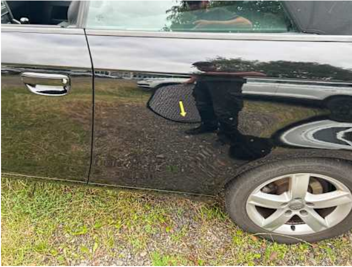
Seitenteil hinten links (Kratzer, Lackschaden)
