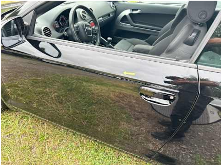
Fahrtür (Kratzer, Lackschaden)
