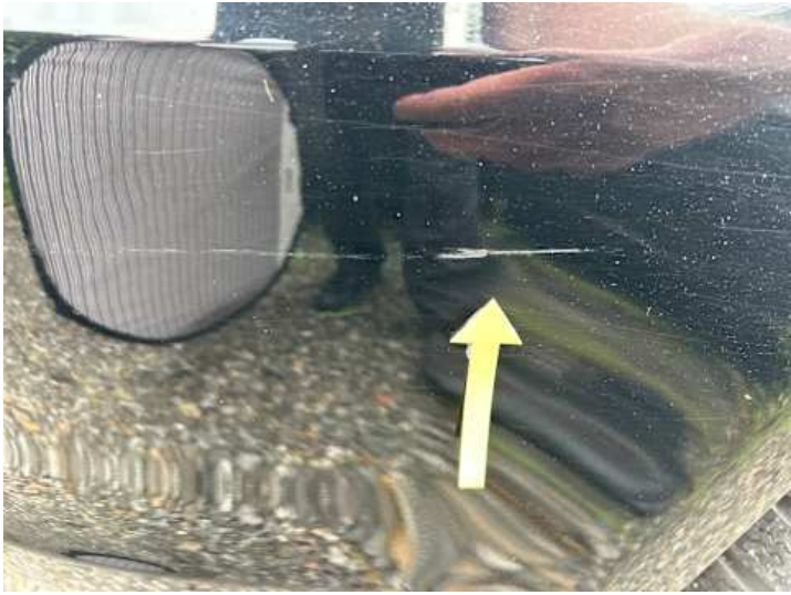
Stoßstange hinten (Kratzer, Lackschaden)
