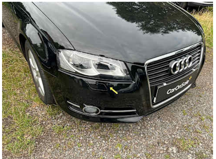
Stoßstange vorne (Lackschaden, Kratzer)
