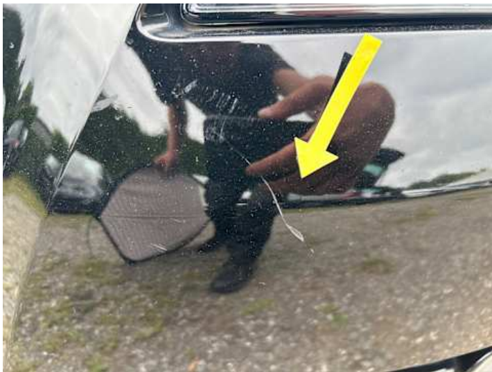
Stoßstange vorne (Lackschaden)
