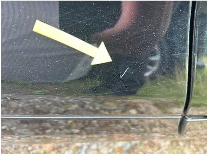
Seitenteil hinten rechts (Lackschaden, Kratzer)
