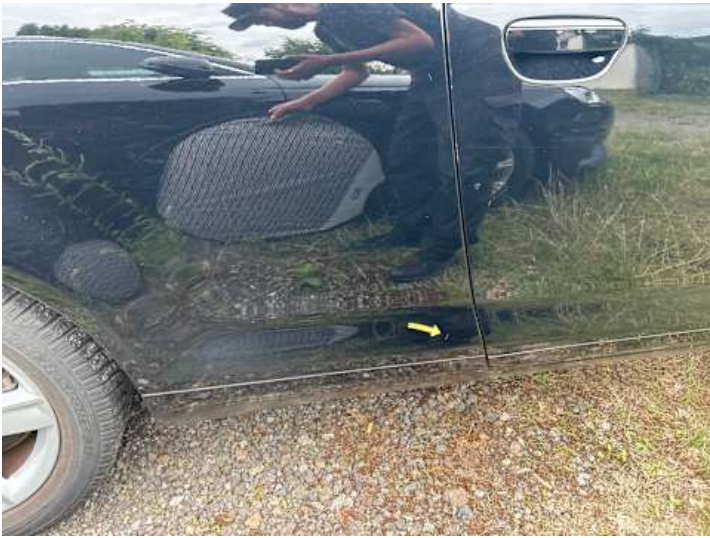
Seitenteil hinten rechts (Lackschaden, Kratzer)
