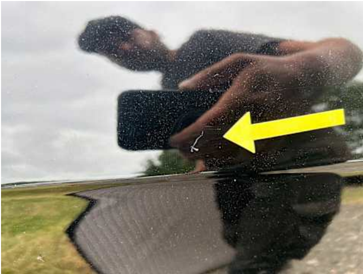
Fahrtür (Kratzer, Lackschaden)
