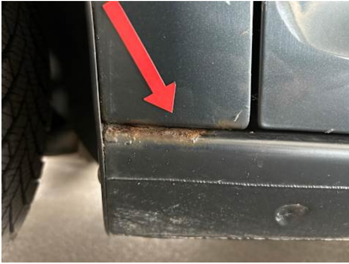
Kotflügel vorne links (Kratzer, Rost)
