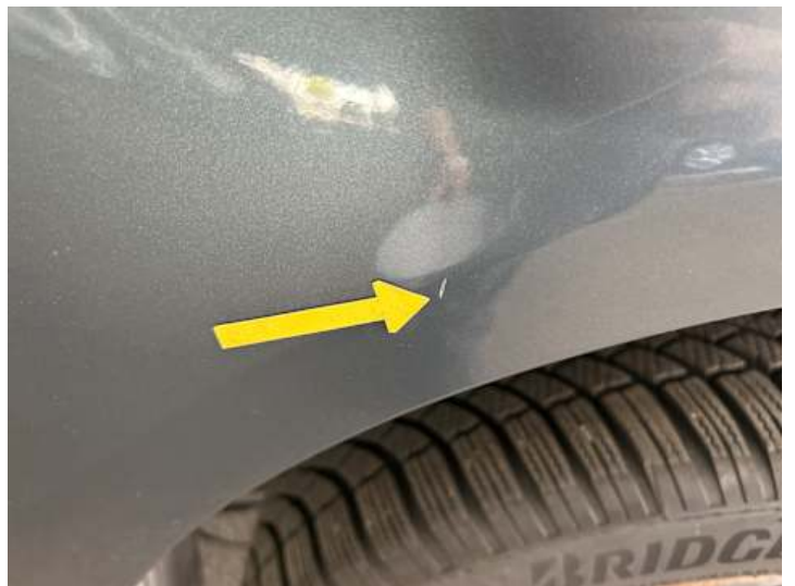
Seitenteil hinten links (Verformung, Kratzer, Delle)
