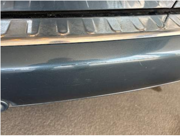
Stoßstange hinten (Kratzer, Lackschaden)
