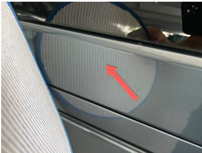
Seitenteil hinten links (Verformung, Kratzer, Delle)
