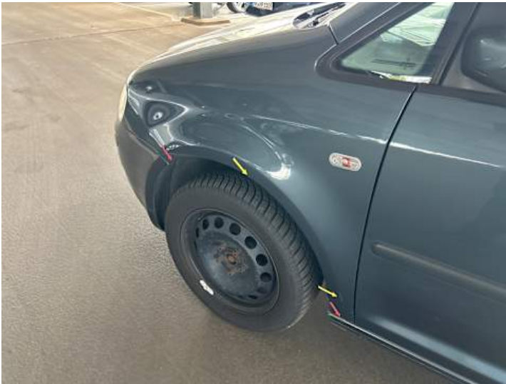
Kotflügel vorne links (Kratzer, Rost)
