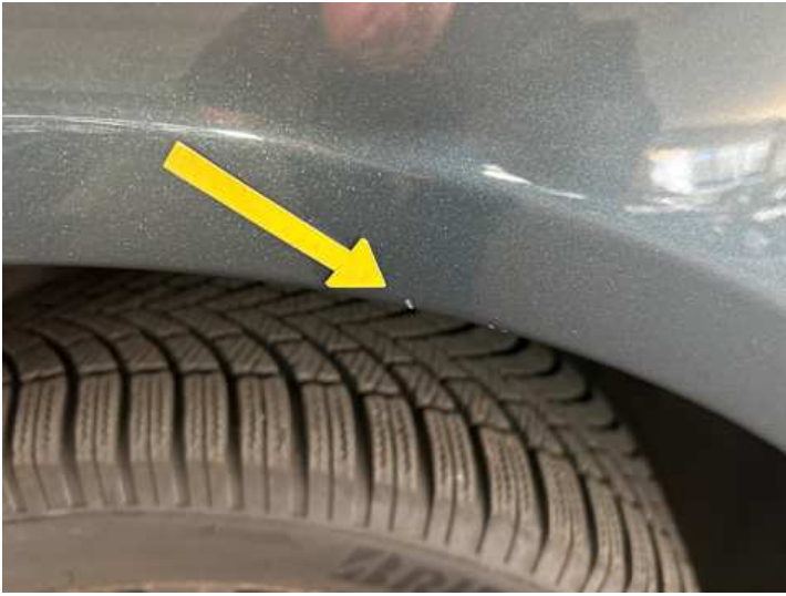
Kotflügel vorne links (Kratzer, Rost)
