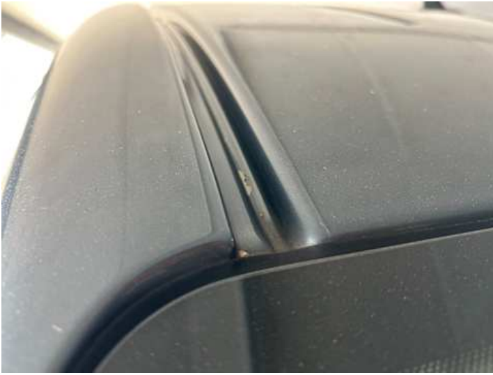
Dach (Rost, Kratzer, Lackschaden)
