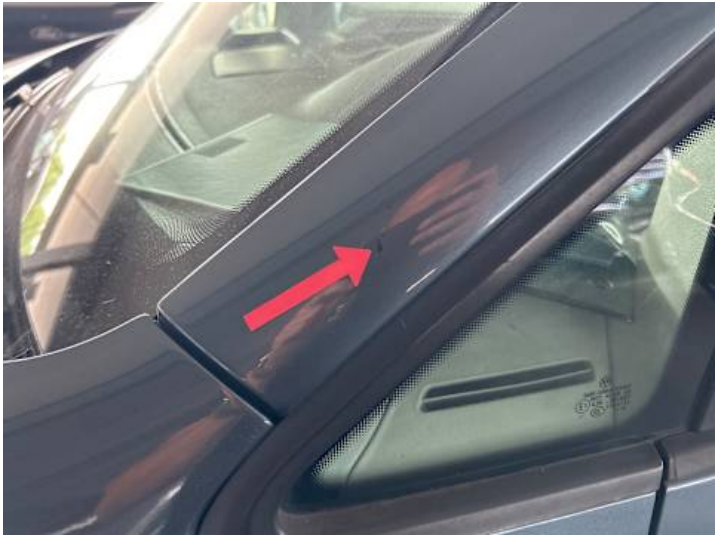
Dach (Rost, Kratzer, Lackschaden)
