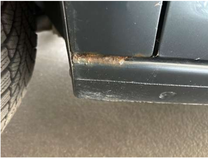
Schweller links (Rost)
