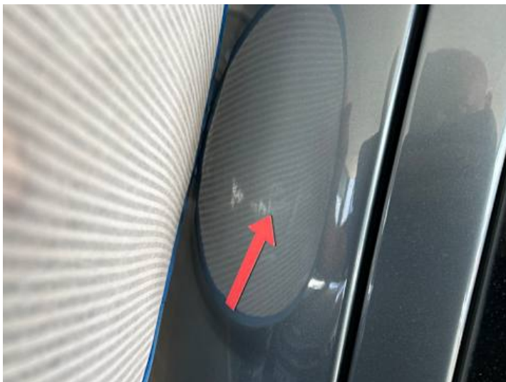
Seitenteil hinten links (Verformung, Kratzer, Delle)
