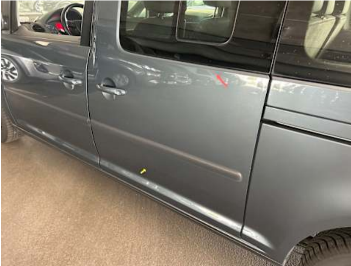
Türe hinten links (Delle, Kratzer)
