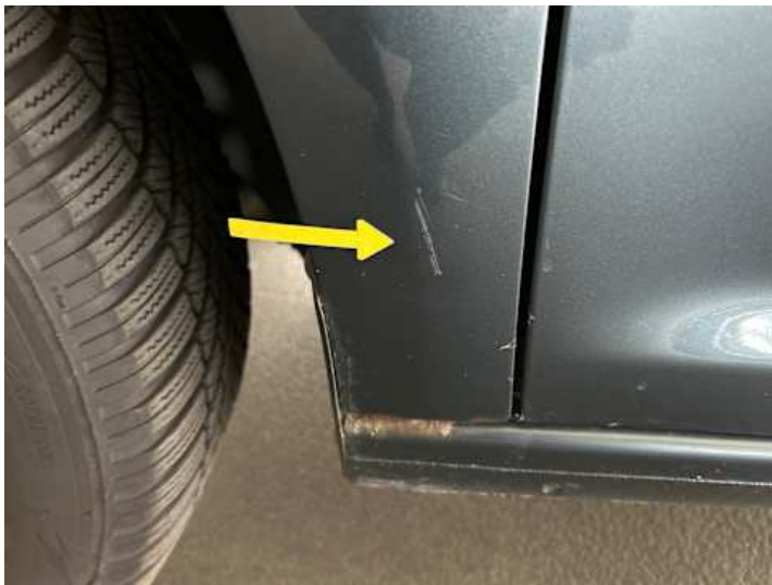
Kotflügel vorne links (Kratzer, Rost)
