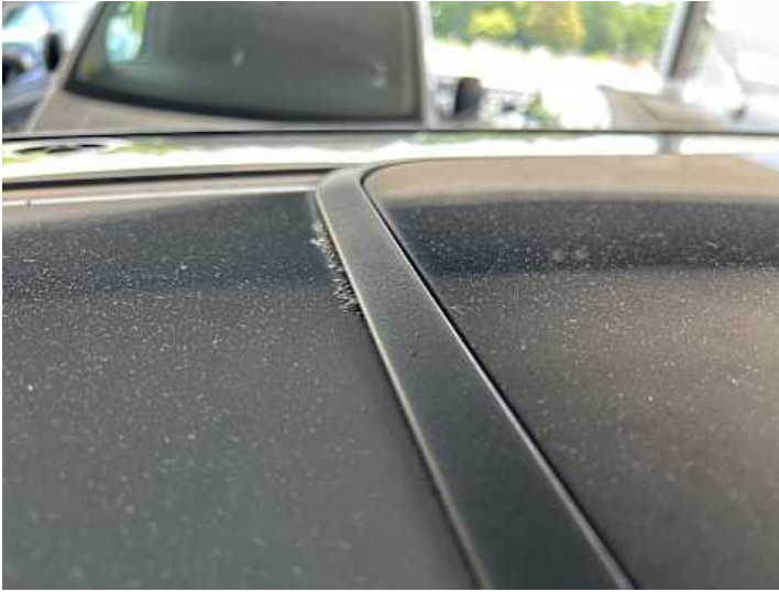
Dach (Rost, Kratzer, Lackschaden)
