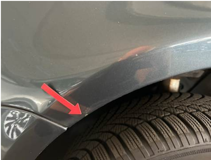
Kotflügel vorne links (Kratzer, Rost)
