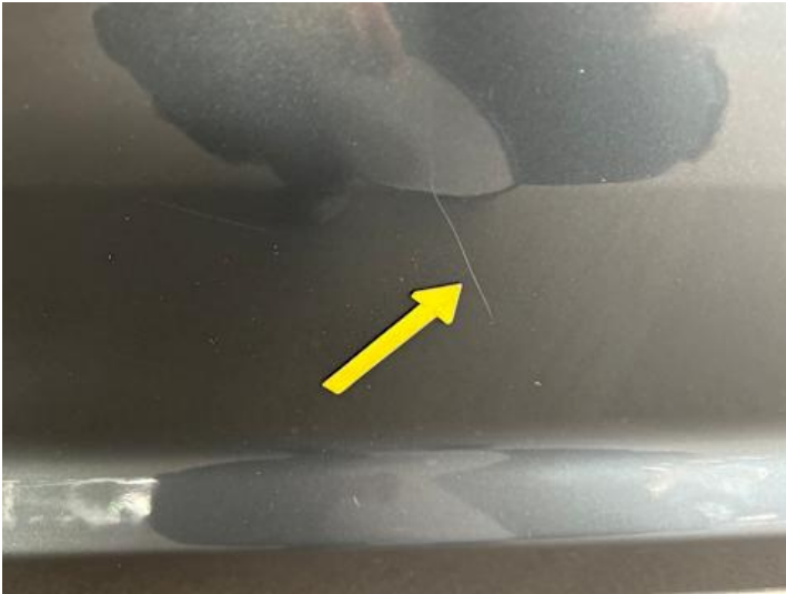
Türe hinten links (Delle, Kratzer)
