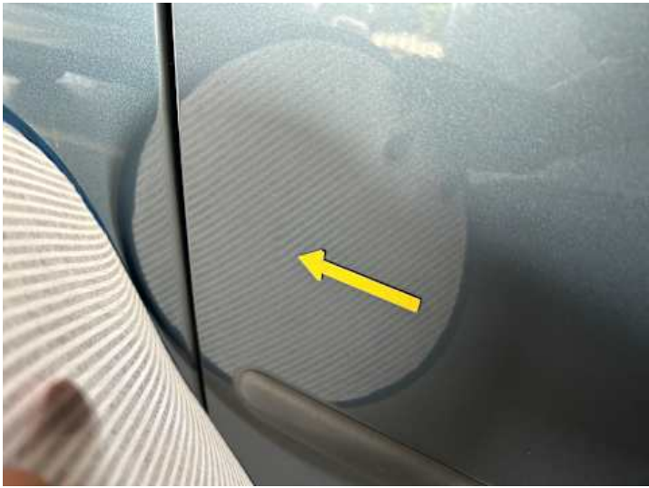
Türe hinten rechts (Delle, Kratzer)
