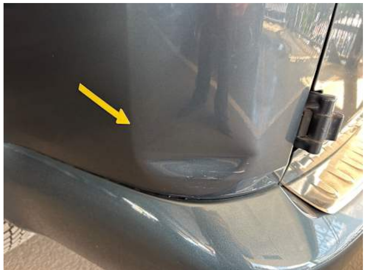
Seitenteil hinten links (Verformung, Kratzer, Delle)
