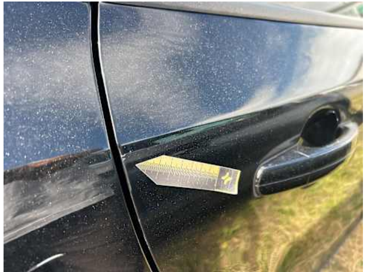
Türe hinten rechts (Kratzer)
