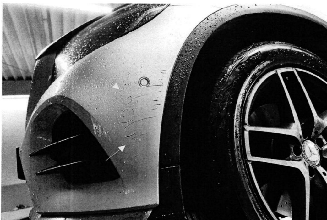
Bild 12 : Stoßfänger vorne verschrammt (Vorschaden)
