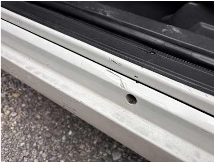
Schweller links (Kratzer)
