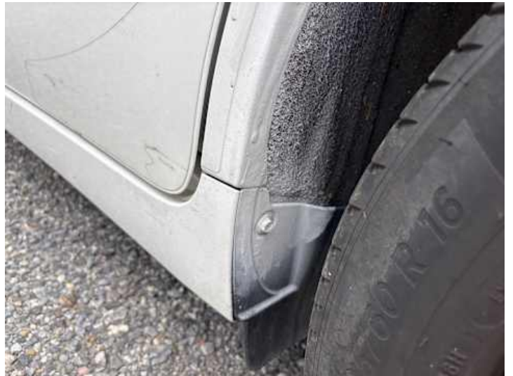
Schweller links (Lackschaden)
