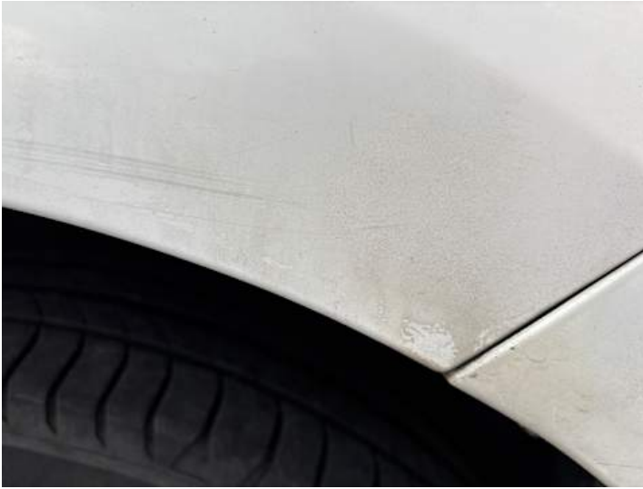
Seitenteil hinten links (Unsachgemäß instand gesetzt, Lackschaden)
