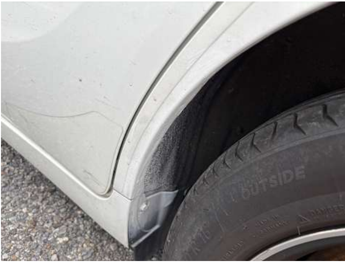
Seitenteil hinten links (Unsachgemäß instand gesetzt)
