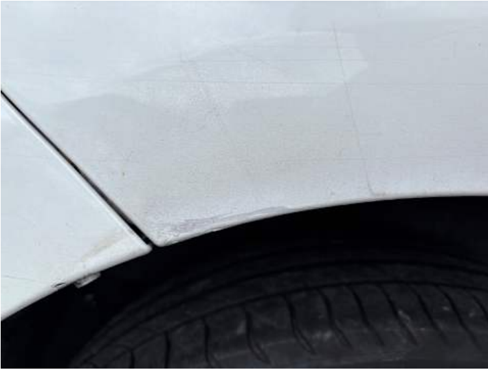
Seitenteil hinten rechts (Unsachgemäß instand gesetzt, Lackschaden)
