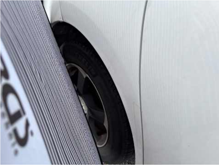
Seitenteil hinten rechts (Unsachgemäß instand gesetzt, Lackschaden)
