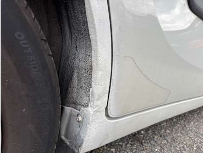
Seitenteil hinten rechts (Unsachgemäß instand gesetzt, Lackschaden)
