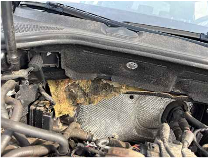
Motorhaube (Anderer Schaden): Dämmung beschädigt
