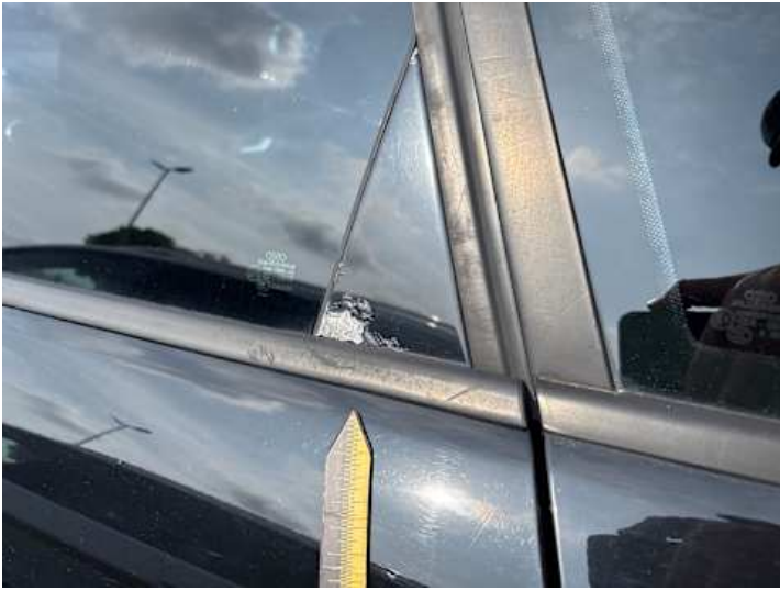
Türe hinten links (Rost)
