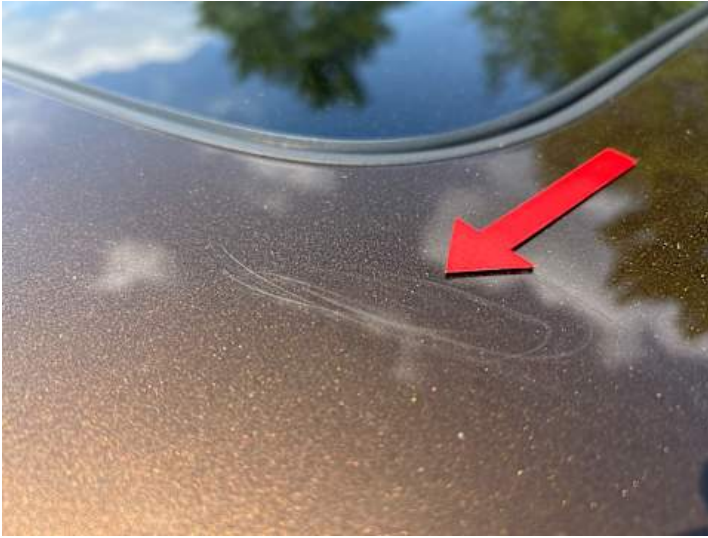
Dach (Kratzer, Lackschaden)
