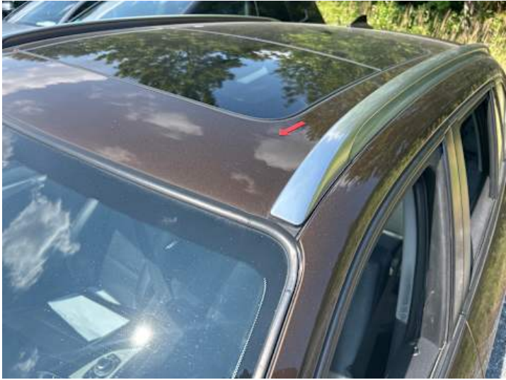
Dach (Kratzer, Lackschaden)
