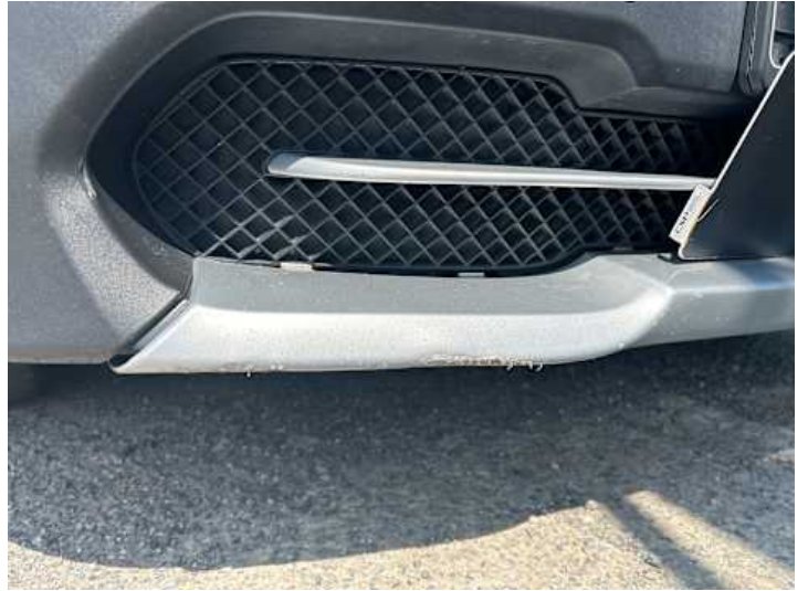
Stoßstange vorne (Spaltmaße ungenau, Kratzer)
