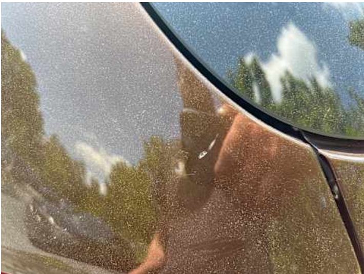
Seitenteil hinten links (Lackschaden)
