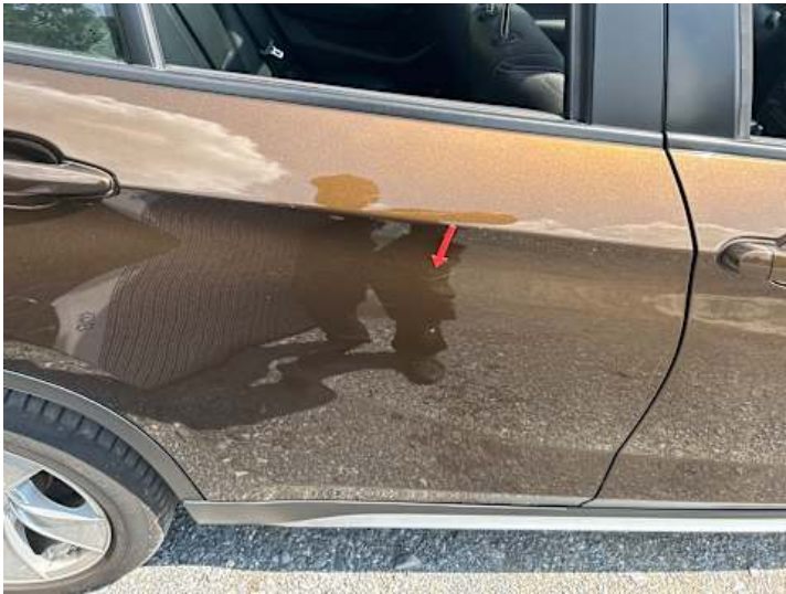
Türe hinten rechts (Kratzer, Lackschaden)
