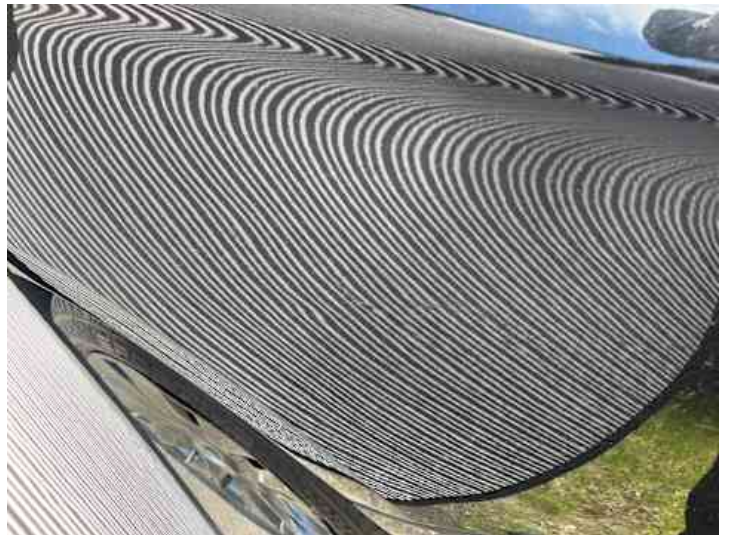
Seitenteil hinten links (Lackschaden, Unsachgemäß instand gesetzt)
