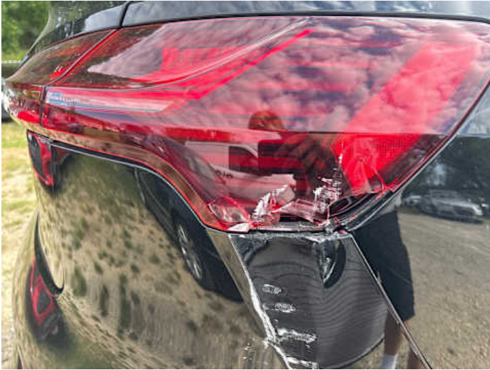
Rücklicht (rechts) (Riss/Bruch)
