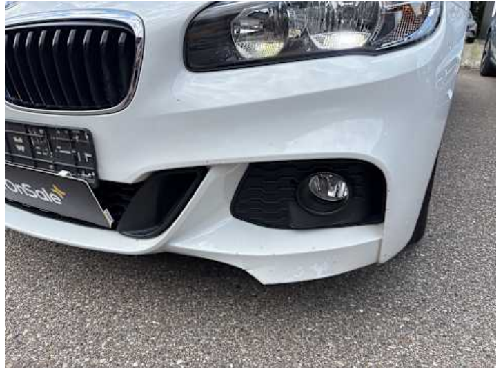
Stoßstange vorne (Verformung, Lackschaden)
