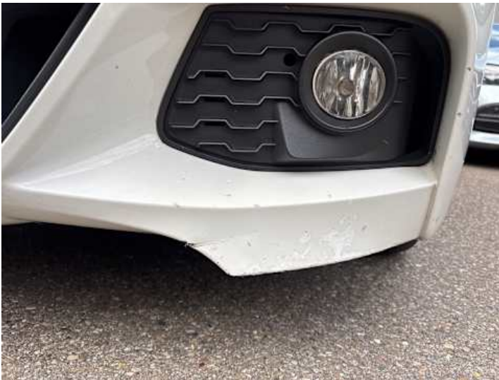
Stoßstange vorne (Verformung, Lackschaden)
