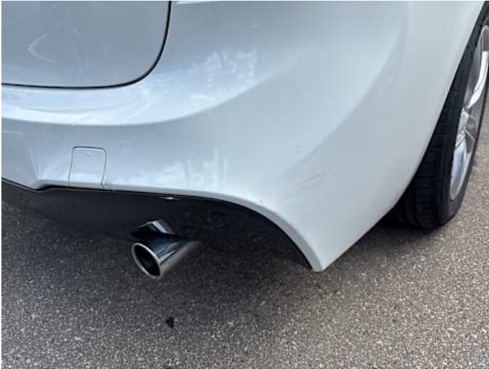
Stoßstange hinten (Kratzer, Lackschaden, Verformung)
