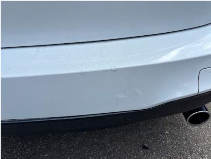
Stoßstange hinten (Kratzer, Lackschaden, Verformung)
