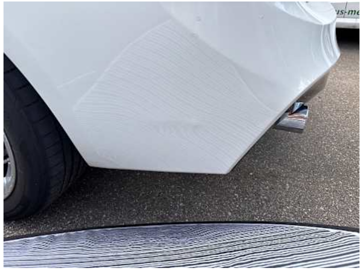
Stoßstange hinten (Kratzer, Lackschaden, Verformung)
