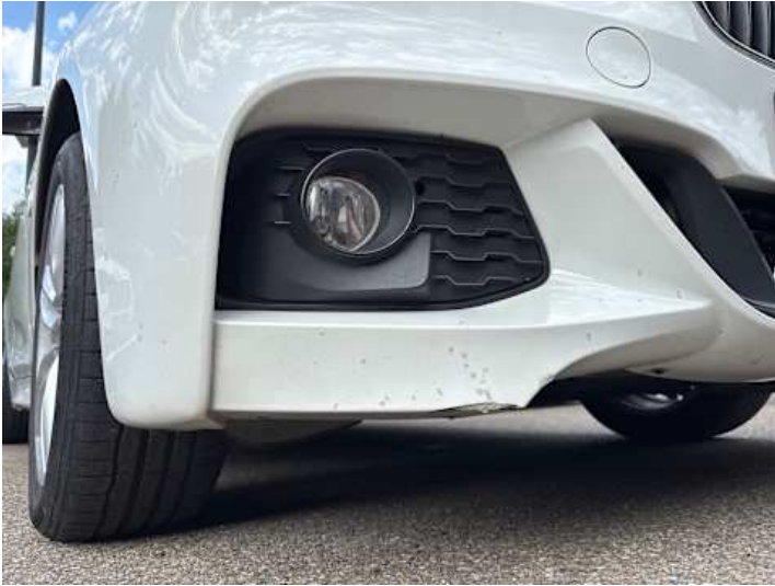
Stoßstange vorne (Verformung, Lackschaden)
