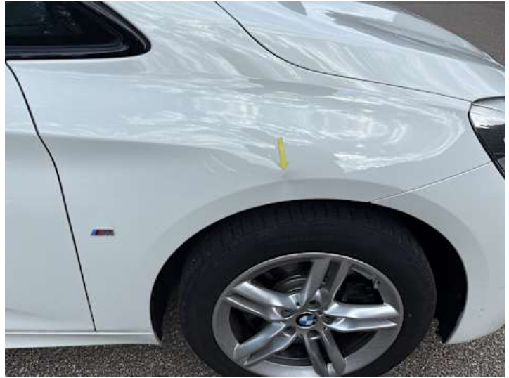
Kotflügel vorne rechts (Verformung, Lackschaden)
