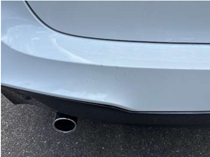
Stoßstange hinten (Kratzer, Lackschaden, Verformung)
