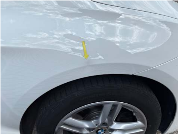
Kotflügel vorne rechts (Verformung, Lackschaden)
