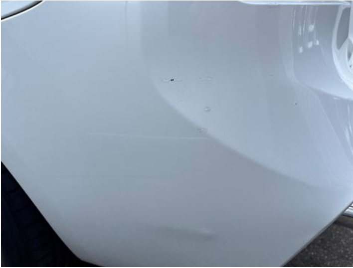
Stoßstange hinten (Kratzer, Lackschaden, Verformung)
