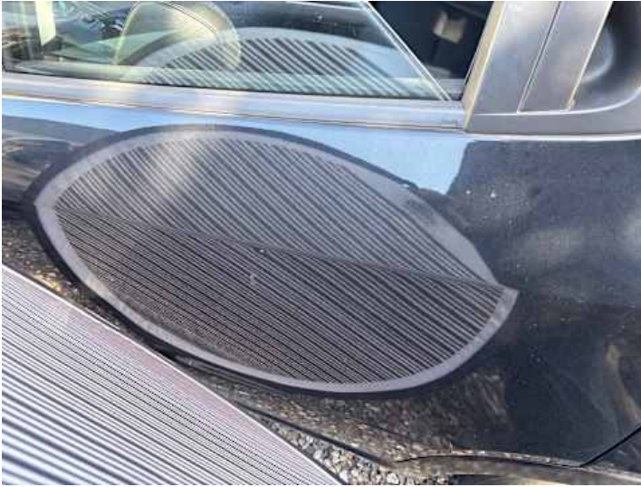
Türe hinten links (Delle)
