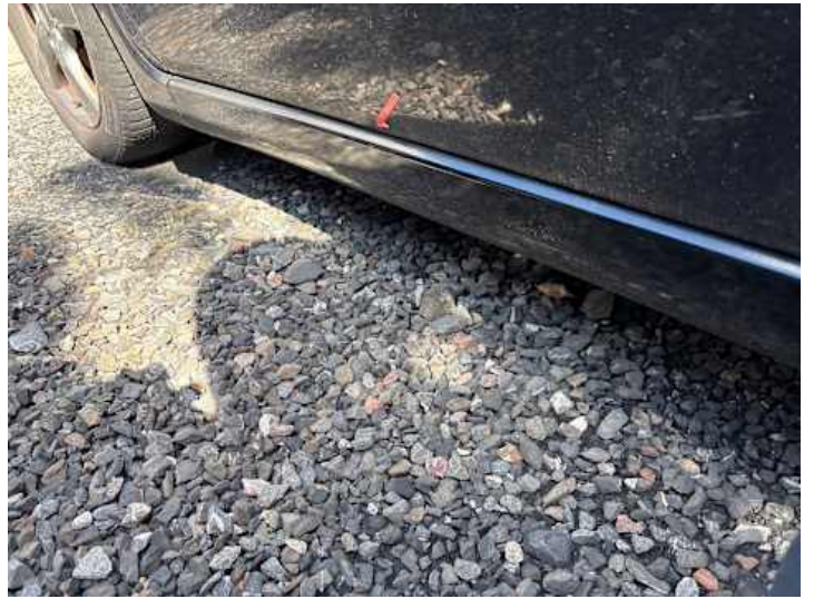
Schweller links (Kratzer)
