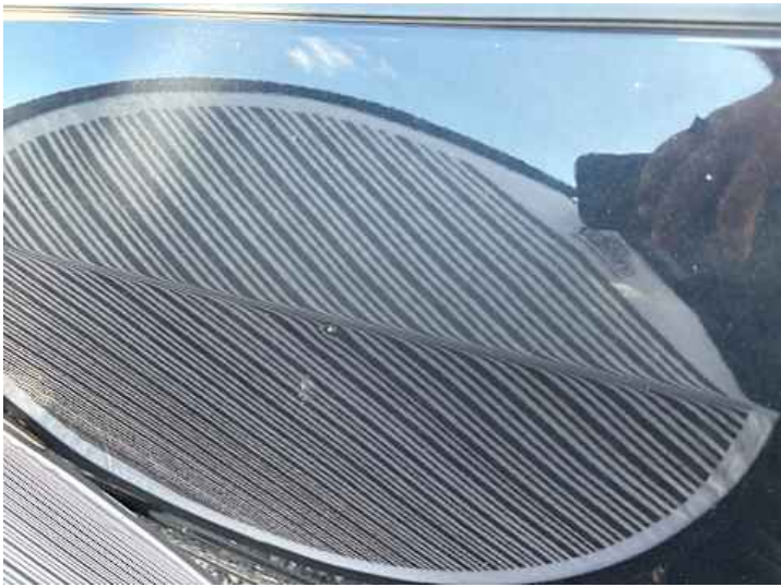
Türe hinten links (Delle)
